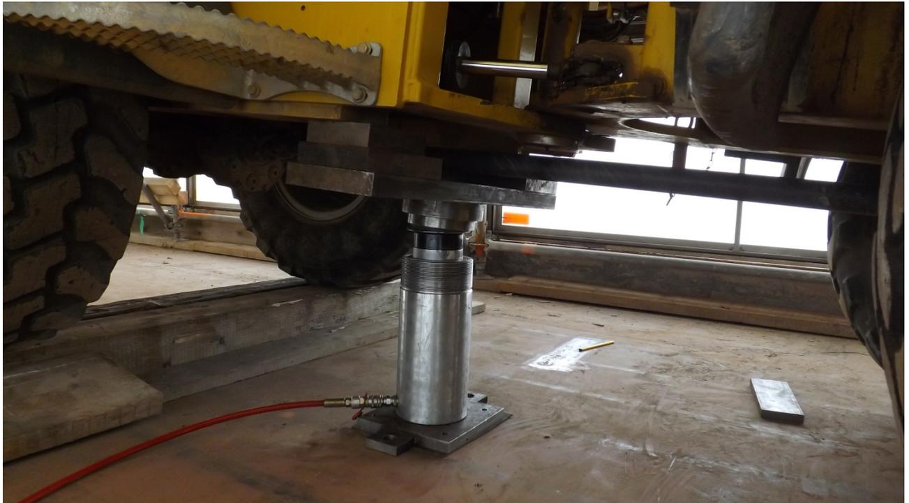
**Abbildung 5: Hydraulikpresse für lokale Belastung mittels Radlader.**
