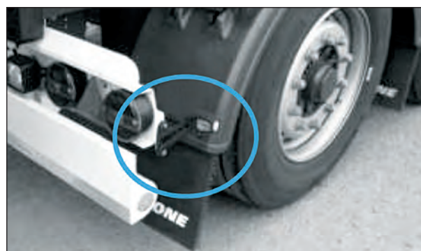
Bild 13: Spurhalteleuchten nach § 51 Absatz 4 der StVZO
