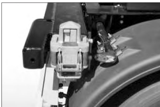
Bild 30: Twistlock zur Aufnahme von Containern und Wechselchassis im Kombinierten Verkehr
