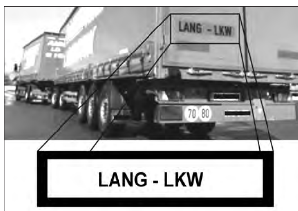
Bild 28: Heckseitige Fahrzeugkennzeichnung der Lang-Lkw-Kombinationen
