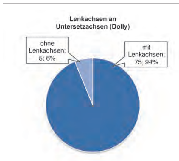
Bild 32: Lenkbarkeit von Untersetzachsen (Dolly); „mit Lenkachsen“ umfasst auch die Lenkbarkeit über eine lenkbare Deichsel
