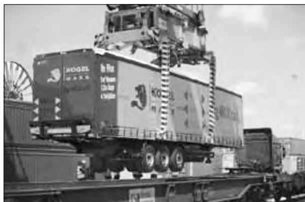
Bild 29: Sattelanhänger mit Krantaschen zur Bahnverladung im kombinierten Verkehr
