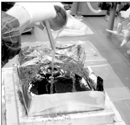
Bild 5: Verfüllung eines hohlräumreichen Asphaltgerüsts mit Epoxidharz im Labor [SED 2010]
