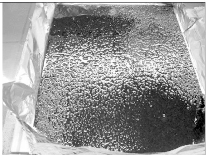
Bild 5: Verfüllung eines hohlräumreichen Asphaltgerüsts mit Epoxidharz im Labor [SED 2010]
