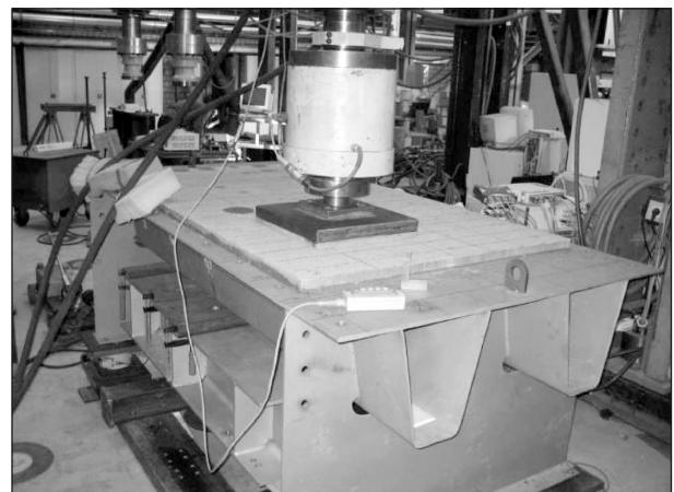
Bild 6: Versuchsaufbau – Fertigteile aus UHPC [UNG 2010]
