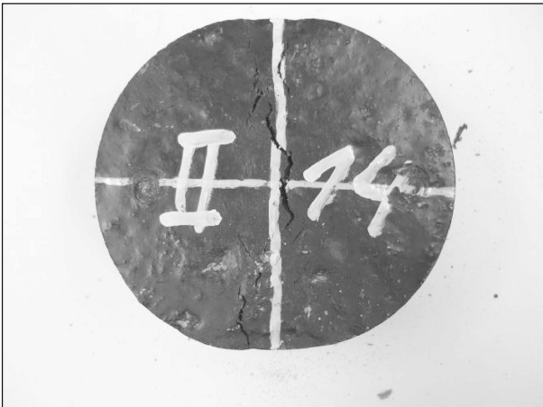
Bild 17: Gerissener und verformter Prüfkörper
