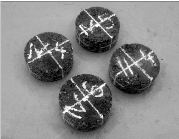
Bild 9: Prüfkörper für Spaltzug-Schwellversuche
