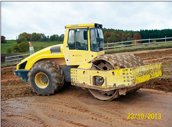
Bild 233: Schafffußwalze Bomag BW 226
