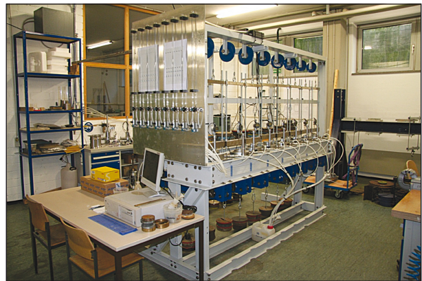
Bild 17: Versuchsstand mit Oedometerzellen und Vorrichtung zur Versorgung der einzelnen Zellen mit Wasser
