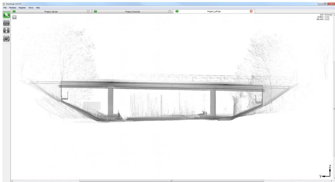
Abbildung 23: Beispiel einer Punktwolke einer Bestandsbrücke (Pointcap 2015)
