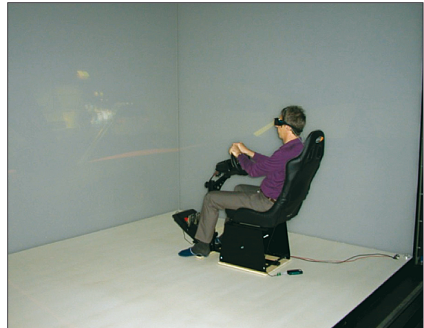
Bild 17: Lenkrad mit Gas- und Bremspedal in der Cave
