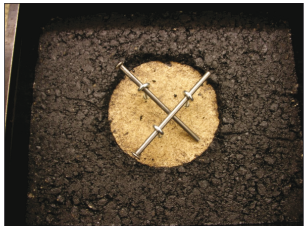
Bild 21: Aushubwerkzeug für Methode V
