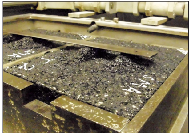
Bild 24: Prüfkörperversagen nach Spurbildungsversuch
