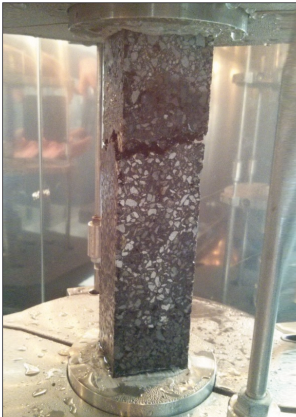
Bild 29: Prüfkörper nach direktem Zugversuch
