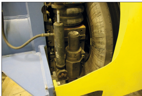
Bild 32: Radaufhängung der Rundlaufanlage
