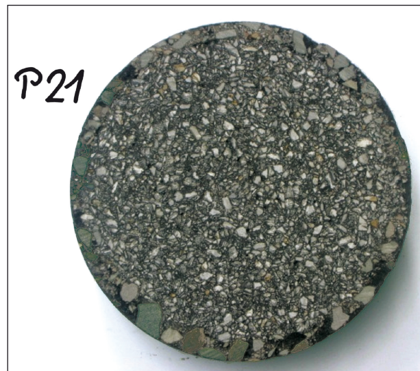
Bild 25: Aufbereiteter Prüfkörper für DSV-BK
