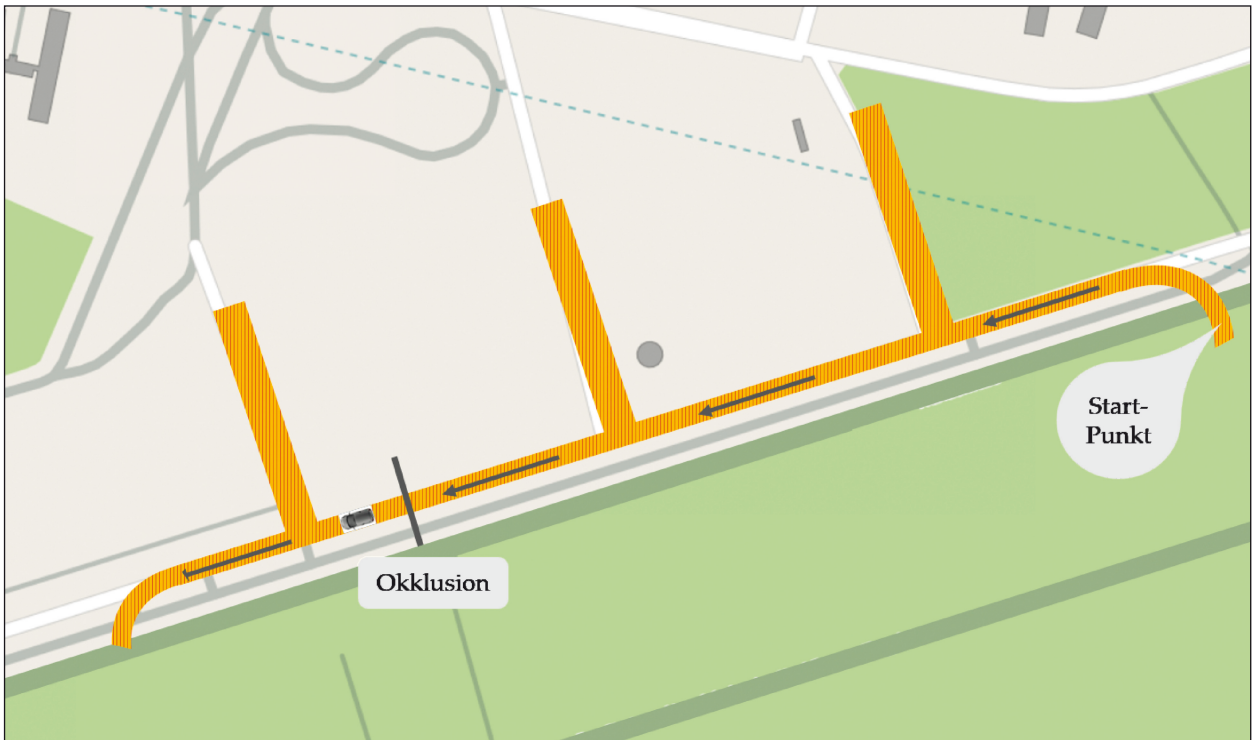
Bild 4: Luftbild und Planskizze des Versuchsgeländes der UBw München. Der gelb schraffierte Bereich zeigt die simulierten Streckenabschnitte. Die Versuchsfahrt erfolgte in Pfeilrichtung
