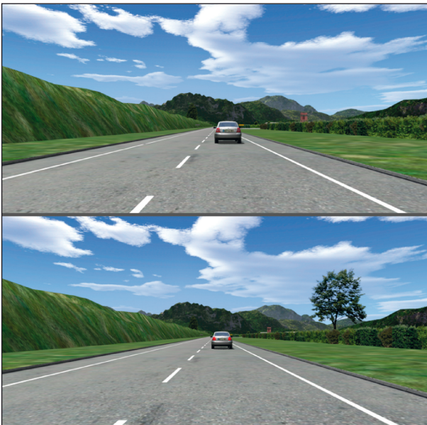
Bild 11: Simulationsmitschnitte des Szenarios „Folgefahrt mit Beschleunigung“ (oben) und des Szenarios „Folgefahrt mit Verzögerung“ (unten) aus Probandensicht
