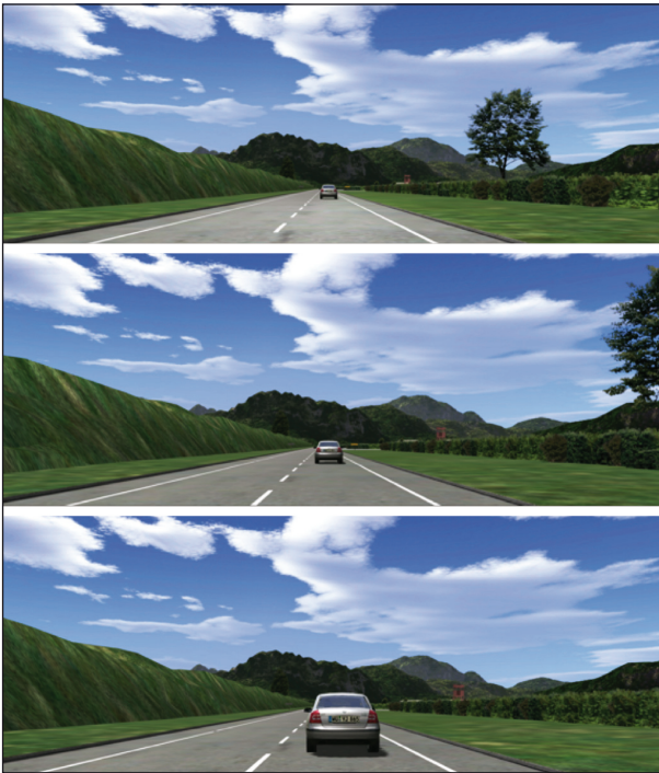
Bild 7: Simulationsmitschnitte des Szenarios „Abstand herstellen“ aus Probandensicht für einen beispielhaften „harmlosen“ Abstand (oben), „unangenehmen“ Abstand (mittig) und „gefährlichen“ Abstand (unten)
