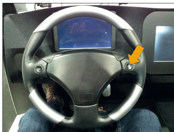
Bild 6: Lenkrad des statischen Fahrsimulators mit Markierung des verwendeten Tasters
