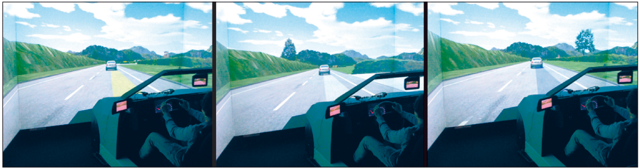
Bild 8: Fahrt im statischen Simulator mit „Enhanced Reality Strip“ (ERS)
