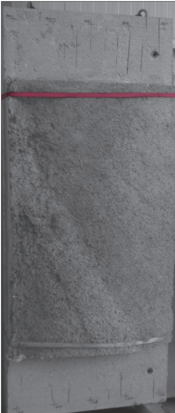
Bild 50: Probekörper RUB 1 nach dem Brandversuch mit modifiziertem Auflagerbereich
