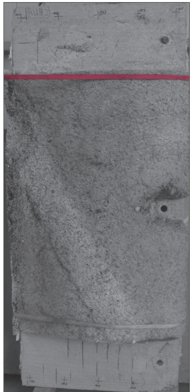
Bild 51: Probekörper RUB 2 nach dem Brandversuch mit modifiziertem Auflagerbereich
