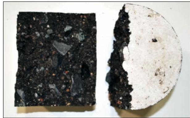
**Bild 54:** Der Probekörper AM6.1 S3 nach Prüfung der Spaltzugfestigkeit
