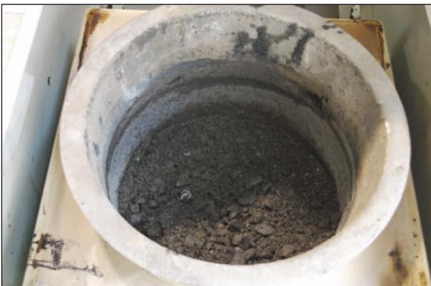
**Bild 59:** Das Asphaltmischgut AM5.1 in dem Labormischer
