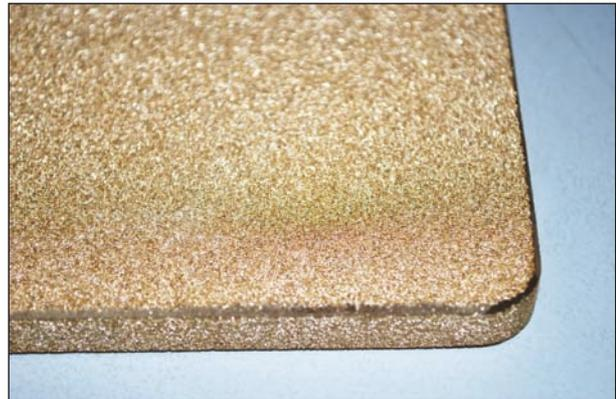
**Bild 60:** Bronze-Filterplatte zum Drainieren des austretenden Wassers
