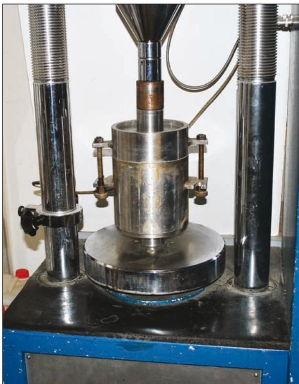
**Bild 53:** Statische Verdichtung des Probekörpers nach dem Doppelkolbenprinzip
