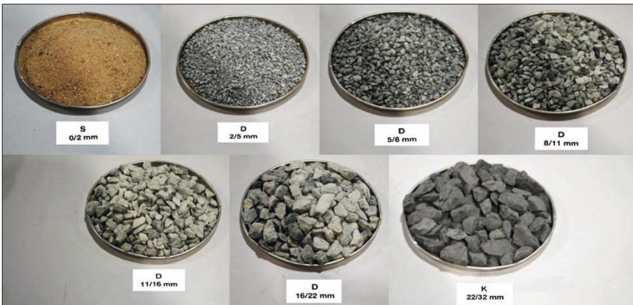
**Bild 30:** Fotos der Proben der verwendeten Kornklassen der Gesteinskörnungen
