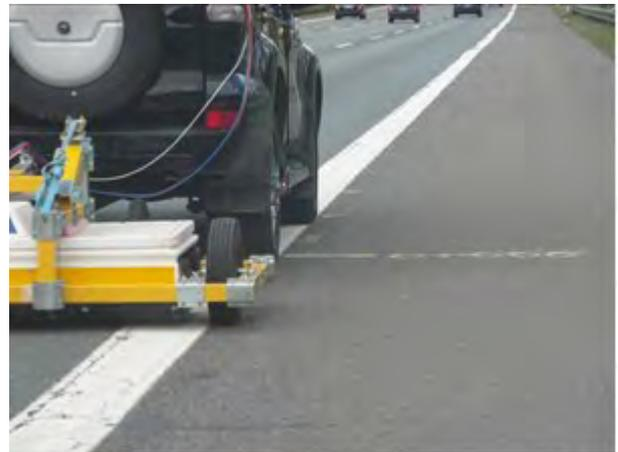
**Abbildung 32:** Position des Messanhängers bei der jeweils ersten Messfahrt auf Asphaltbefestigungen
