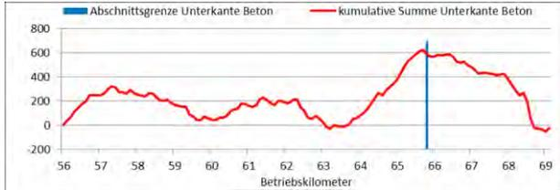
**Abbildung 78:** Georadar-Detektionen der Unterkante Beton – Sechste Unterabschnittsbildung nach dem Verfahren der kumulativen Summen
