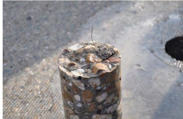
**Abbildung 67:** Bohrkern aus Stahlfaserbeton
