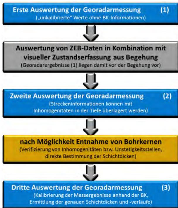
**Abbildung 219:** Iterative Vorgehensweise im Rahmen der Georadarauswertung
