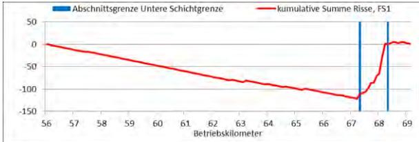
**Abbildung 83:** Visuelle Zustandsaufnahme von Rissbildungen – erste Unterabschnittsbildung nach dem Verfahren der kumulativen Summen
