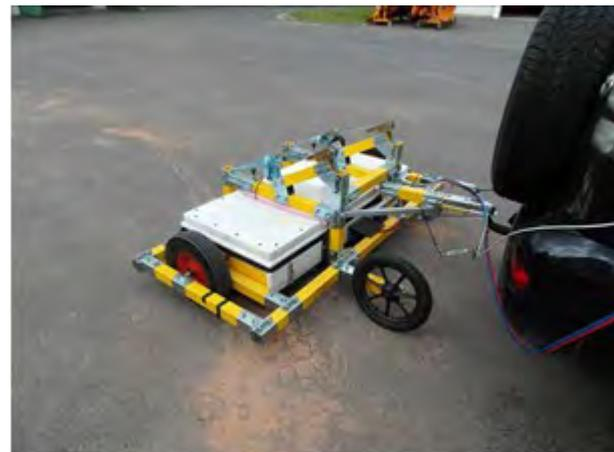
**Abbildung 28:** Messvorbereitung - Installation des Messanhängers mit dem Radarscanner
