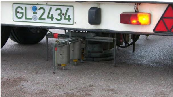
**Abbildung 43:** Anordnung der Geofone an Messbalken (Rückansicht)
