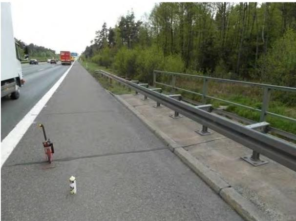
**Abbildung 61:** Erfassung von Abschnittsgrenzen (Querfugen an Bauwerken)
