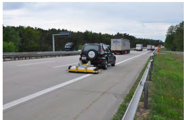
**Abbildung 24:** Rückansicht der Position des Messanhängers während der ersten Messfahrt (Betonbefestigung)
