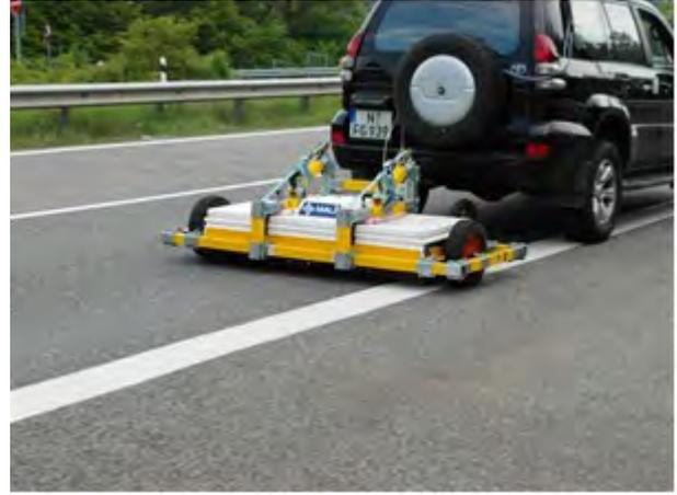
**Abbildung 31:** Erfassung des rechten Bereiches im Hauptfahrstreifen mit den jeweils ersten Messfahrten (Asphaltbefestigungen)
