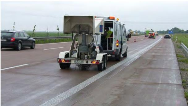
**Abbildung 42:** FWD-Messung in Plattenmitte des ersten Fahrstreifens (Betonbefestigung)
