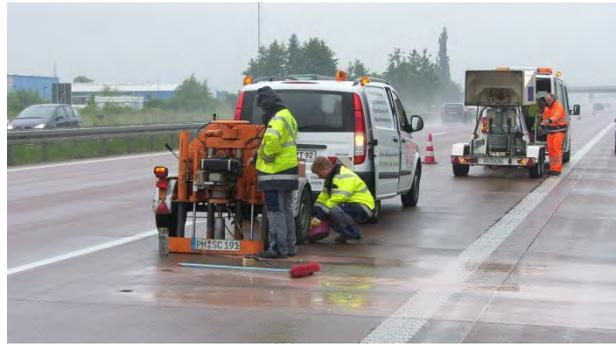
**Abbildung 62:** Bohrkernentnahme im ersten Fahrstreifen, hinten im Bild FWD-Messung
