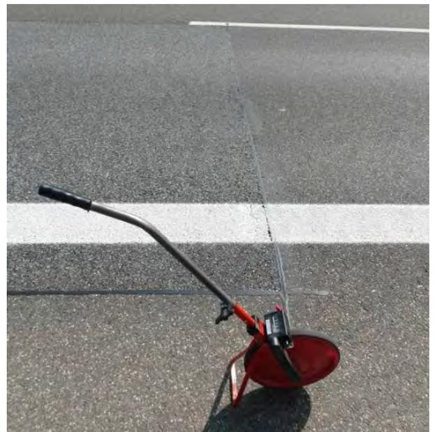
**Abbildung 59:** Erfassung von Abschnittsgrenzen (Ende der Deckschichterneuerung)
