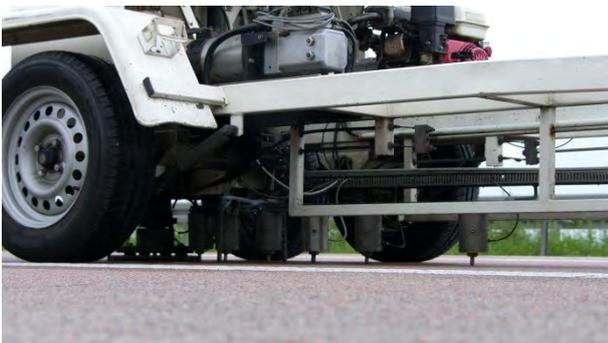
**Abbildung 44:** Anordnung der Geofone an Messbalken (Seitenansicht)
