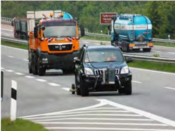
**Abbildung 30:** Verkehrssicherung während der Georadarmessungen (Ansicht von vorn)
