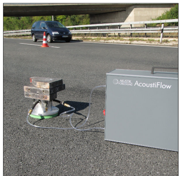
Bild 4.14: Messtechnische Bestimmung des effektiven spezifischen Strömungswiderstands der Fahrbahnoberfläche mit Messsystem AFD – 300 AcoustiFlow®
