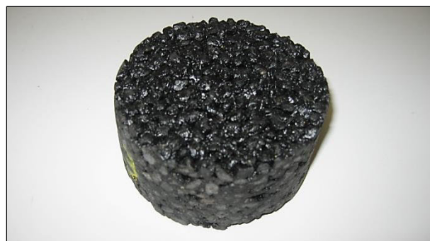
Bild 4.7: Bohrkern eines Fahrbahnbelags aus offenporigem Asphalt (OPA)
