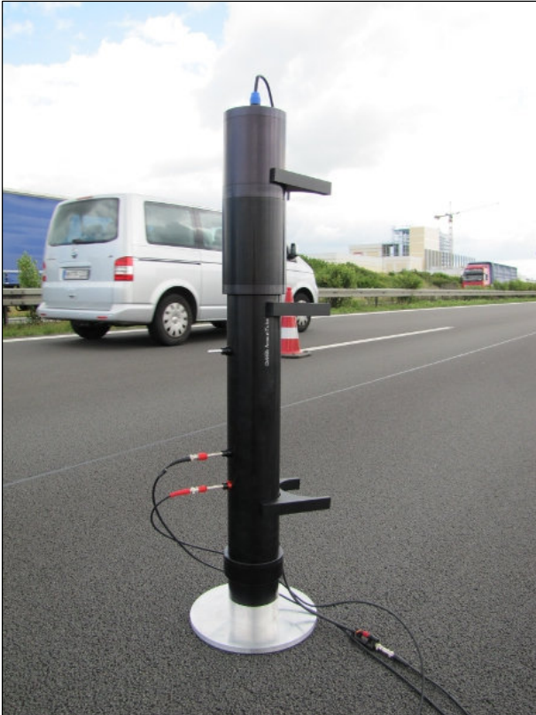
Bild 4.22: Messtechnische Bestimmung des Schallabsorptionsgrads der Fahrbahnoberfläche auf Basis des Impedanzrohr-Verfahrens mit dem Messsystem AFD 1000 - AcoustiTube®
