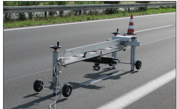
Bild 4.3: messtechnische Bestimmung des Profils der Fahrbahnoberfläche mit 3D-Laser-Profilmeter
