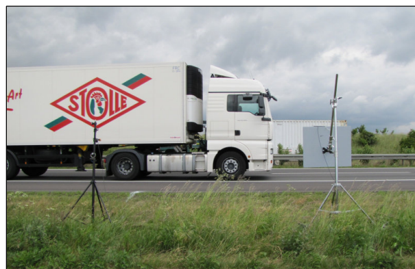
Bild 3.5: Zeitgleiche Anwendung von SPB-Verfahren und „Backing-Board“-Methode
