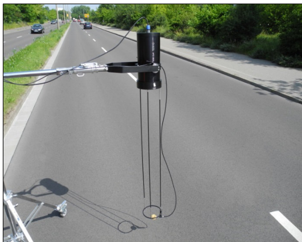
Bild 4.18: Messtechnische Bestimmung des Schallabsorptionsgrads der Fahrbahnoberfläche auf Basis des Freifeld-Verfahrens mit dem Messsystem AFD 800
