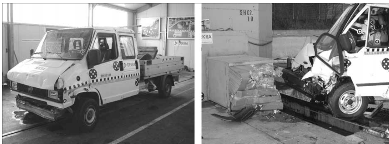
Bild 11: Vergleichstests älterer Fiat Ducato (Bj. 1994) mit 32 km/h und voller Überdeckung gegen die starre Barriere und Offsetcrash mit einem Ford Transit bei 48 km/h Anprallgeschwindigkeit mit 40 % frontaler Überdeckung am Deformationselement
