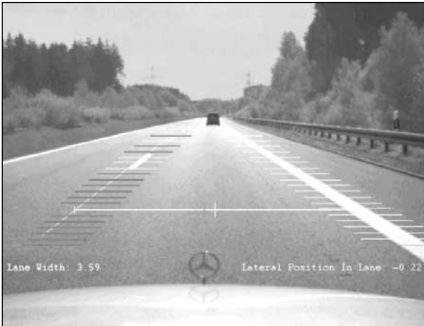
Bild 23: Spurerkennung durch Kamera; (Appikation: LKS, ...)
