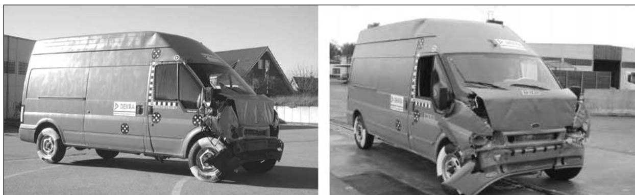
Bild 10: Ergebnisse zweier DEKRA-Crashtests mit einer Geschwindigkeit von 48 km/h
