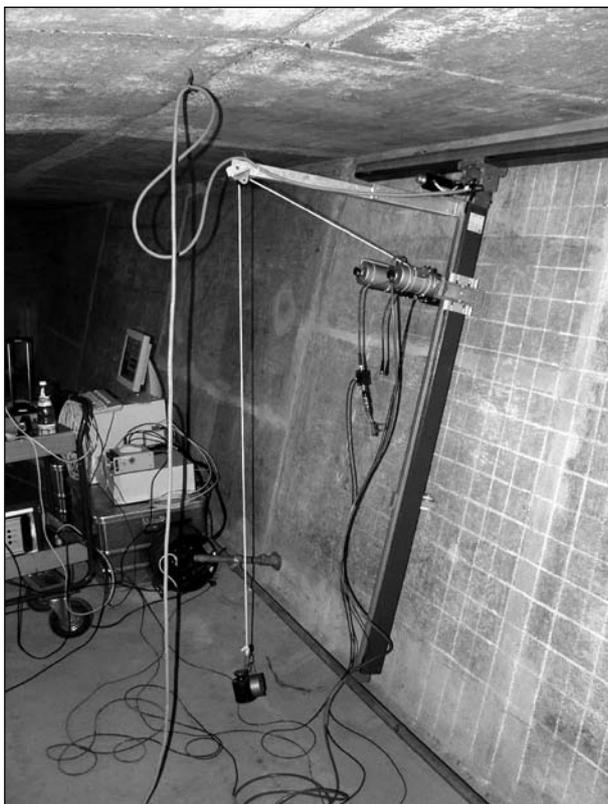
**Bild 10:** Scannerbetrieb am Hohlkastensteg
