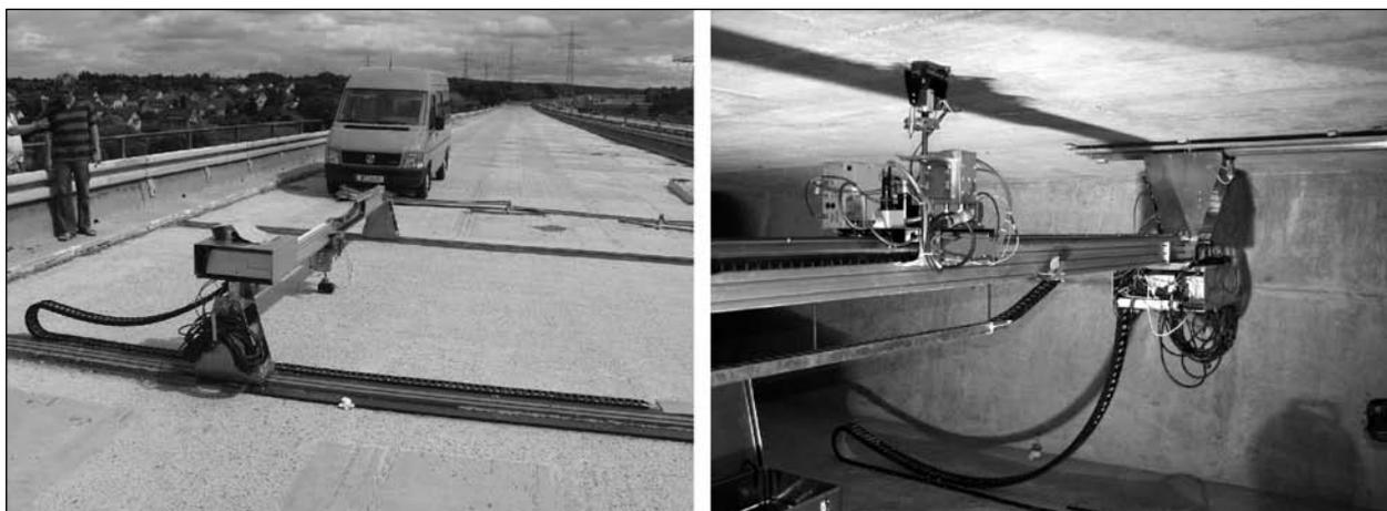
**Bild 8:** Scannerbetrieb; links: auf der Fahrbahnplatte, rechts: an der Hohlkastendecke
