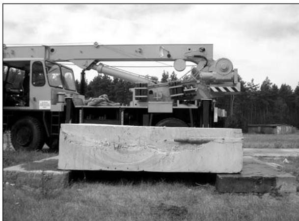
**Bild 46:** Probekörper aus dem Hohlkastensteg, Lagerung auf dem Testgelände der BAM in Horstwalde
