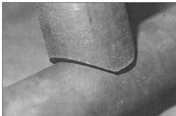
Bild 6-4: Schweißkantenvorbereitung durch Sägeschnitte [MANG, BUCAK 1993]
