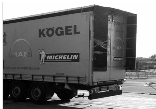
Bild 24: Prototypische Umsetzung von Heck-einzugsklappen
