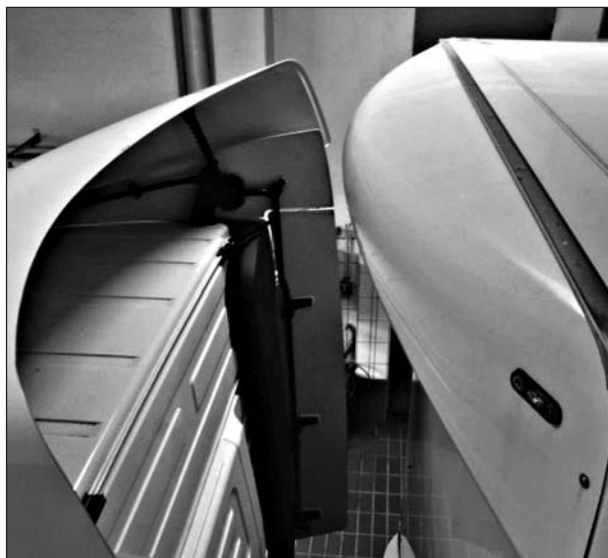
Bild 17: Luftleitkörper an Aufliegerstirnwand, Quelle: (GROßART 2011)
