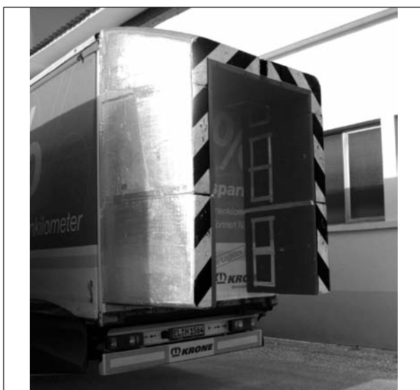
Bild 15: Abgerundeter Heckeinzug mit einer Länge von 1.200 mm
