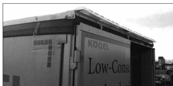
Bild 16: SDR-Diffusor mit einer Höhe von 70 mm
