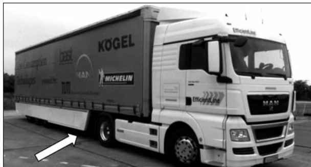
Bild 11: Seitenverkleidung mit vertikalem Flügelprofil
