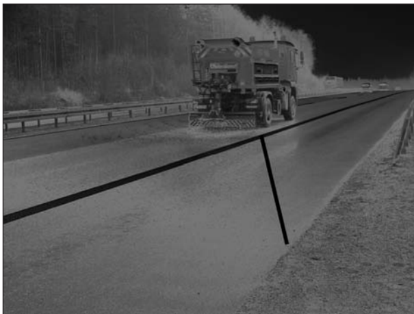
Bild 65: Verwirbelung von Streustoff nach dem Auftreffen auf die Fahrbahn (solarisierte Darstellung -Streustoff schwarz)
