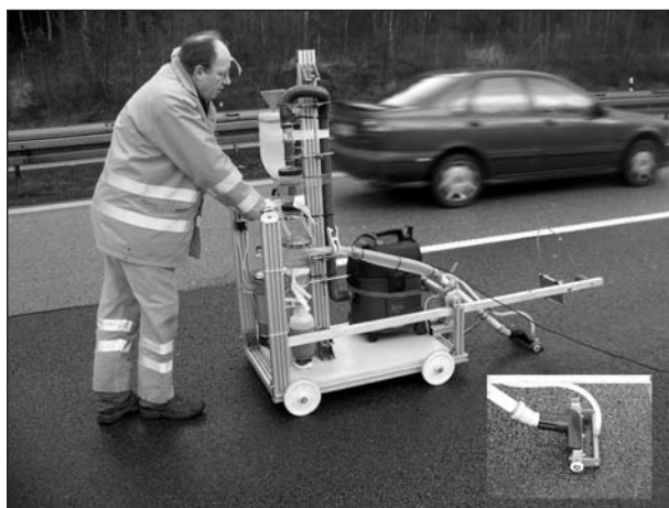
Bild 64: Salzaufnahme mit dem ESG-Gerät; Detail: Saugmund mit Befeuchtungsdüsen, 20 cm breit
