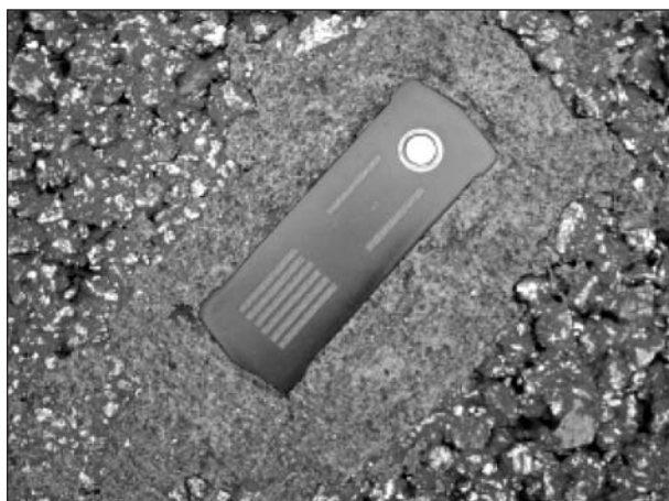
Bild 18: Struktur der Fahrbahnoberfläche in der Umgebung des Sensors
