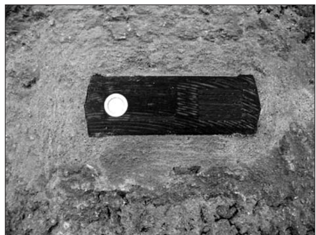
Bild 25: Sensor Fa. Vaisala – Einbauzustand
