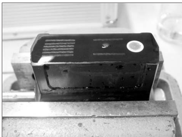
Bild 13: Sensor Fa. Vaisala mit aufgetragenem Salzlösungsfilm beim Labortest
