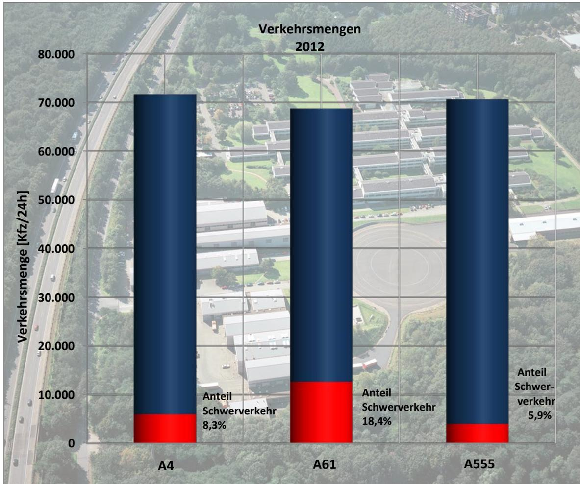
Abb. 10: Gegenüberstellung des durchschnittlichen täglichen Verkehrs und des prozentualen Schwerverkehrsanteils der Messquerschnitte an den Bundesautobahnen A4, A61 und A555 (Bezugsjahr 2012, Quelle: BASt Referat V2)
