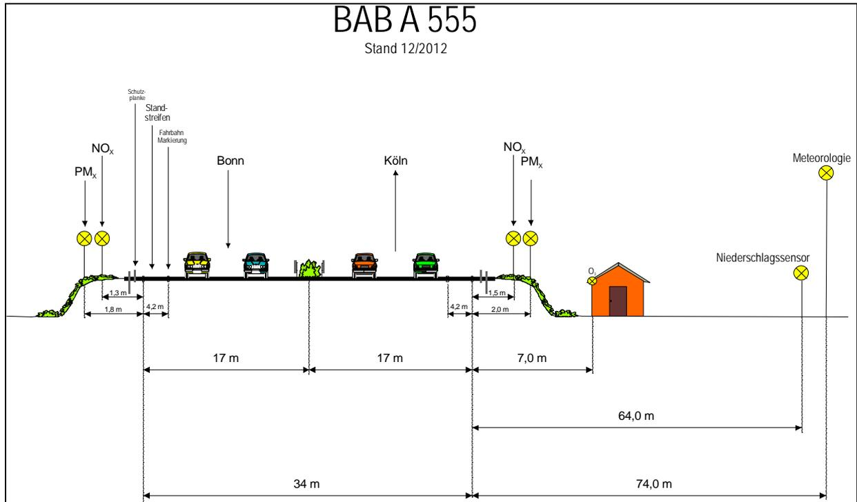
Abb. 7: Schematische Darstellung des Messquerschnitts an der BAB 555
