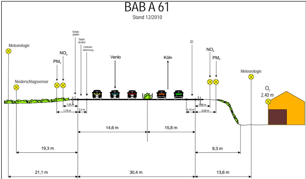
Abb. 4: Schematische Darstellung des Messquerschnitts an der BAB 61
