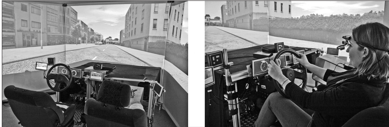
Bild 3: Statischer Fahrsimulator der Ingenieur- und Verkehrspsychologie und Testfahrerinnen mit aufgesetztem Blicksystem (links)
