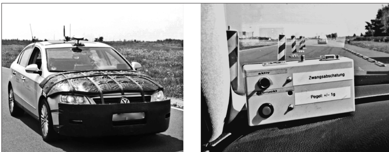
Bild 7: Versuchsfahrzeug mit Frontschutz (links) und versteckter Kamera (rechts)
