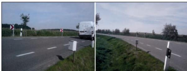
**Bild 3.24:** Seitenradarmessung am Messquerschnitt K 7730 (2)
