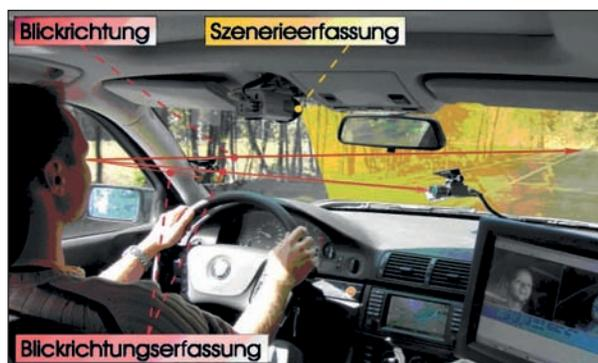
**Bild 3.15:** Blickbewegungsmesssystem Smart Eye im Messfahrzeug der TU Dresden
