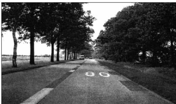
**Bild 2.13:** Design der geschwindigkeitsreduzierenden Maßnahme in Drenthe (van der HORST, 2004)
