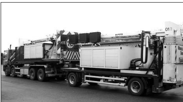
Bild 7: Transport der mobilen Fahrstreifensignalisierung (zwei Schilderbrücken) auf einem Fahrzeug
