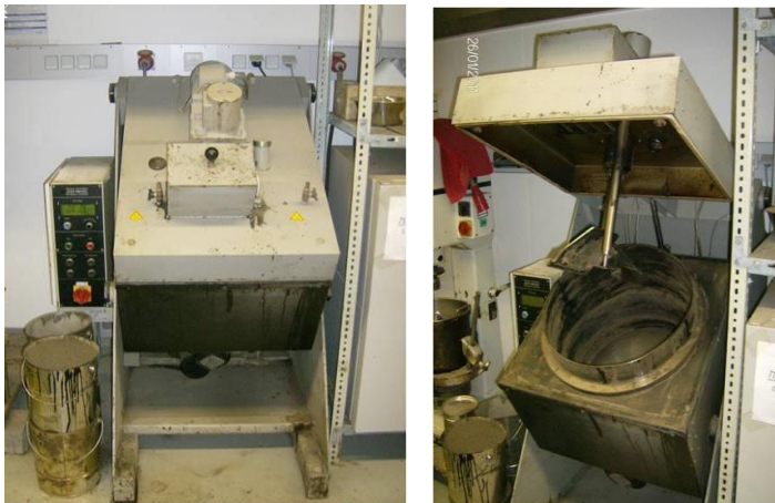
Bild 1-4: Im Labor eingesetzter, handelsüblicher, Gegenlauf-Zwangsmischer mit Aufzeichnung der Mischarbeit
