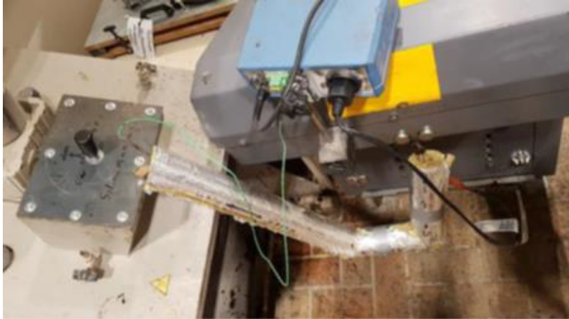
Bild 1-11: Direktes Einspritzen von Schaumbitumen aus dem Schaumbitumen-Apparat (rechts) in den Labormischer (links)
