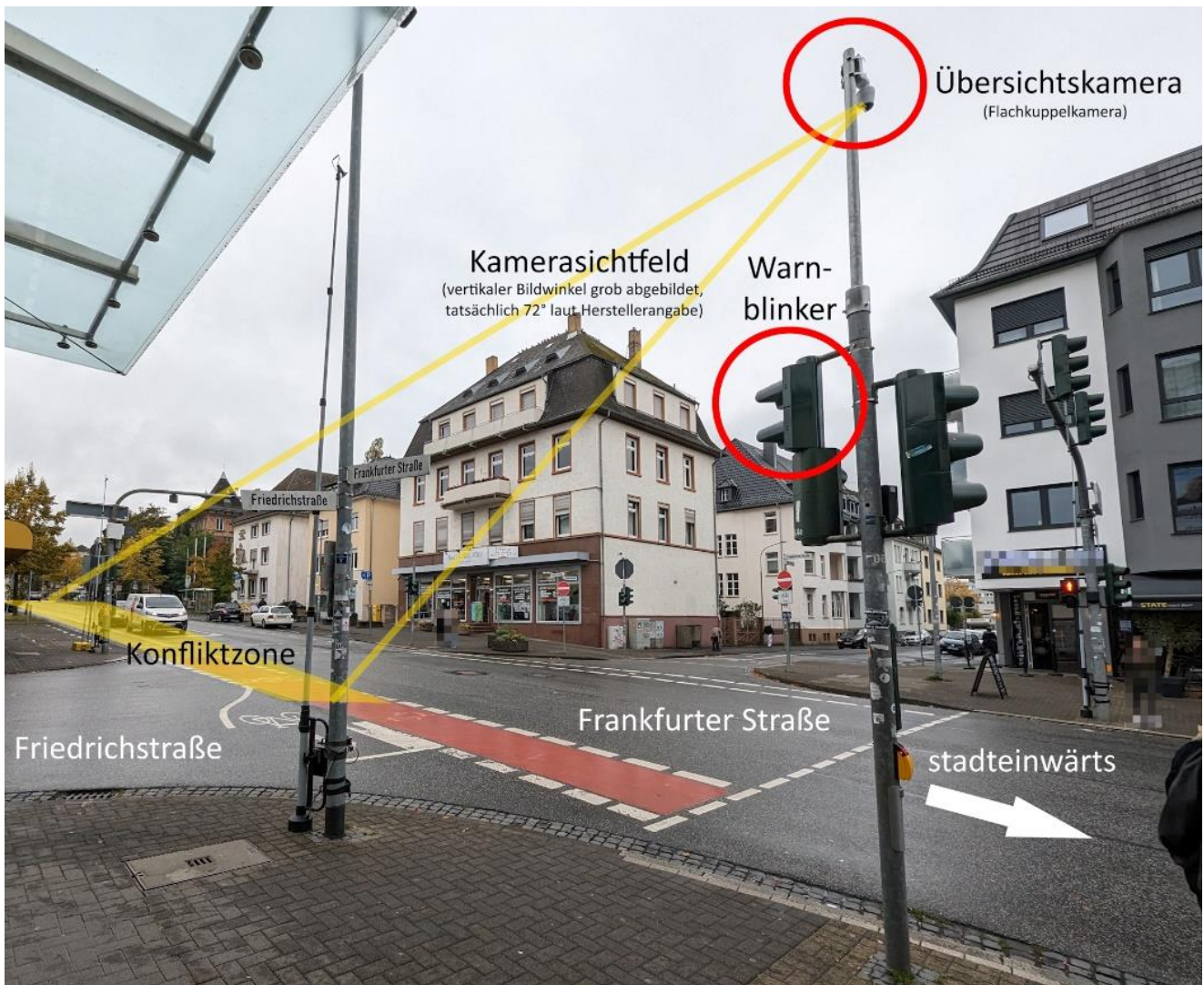
Bild 1: Abbiegeassistenzsystem am Knotenpunkt in Gießen im Oktober 2023
