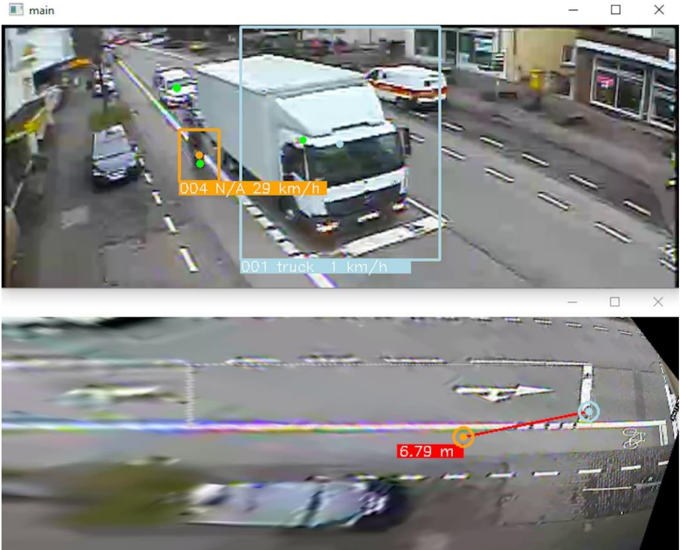
Bild 2: Beispiel für eine Geschwindigkeits- und Abstandsmessung in einer Videoanalyse
