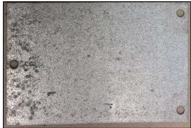
Bild 37: Zinkblech Vorderseite Freibewitterung unter der Brücke Hilfsjoch III
