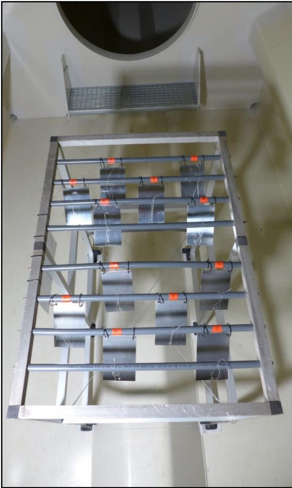
Bild 27: Das Versuchsgestell mit Eisen- und Zinkproben für die Auslagerung der Standardproben gemäß DIN EN ISO 9226 im Hohlkasteninneren. [Foto: Institut für Korrosionsschutz Dresden GmbH]
