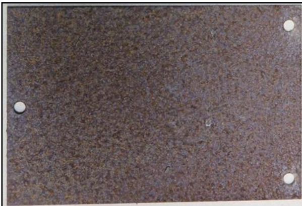
Bild 36: Stahlblech Vorderseite Freibewitterung unter der Brücke Hilfsjoch III
