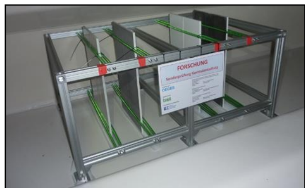
Bild 40: Das Gestell mit den Probekörpern [Foto: DEGES GmbH]
