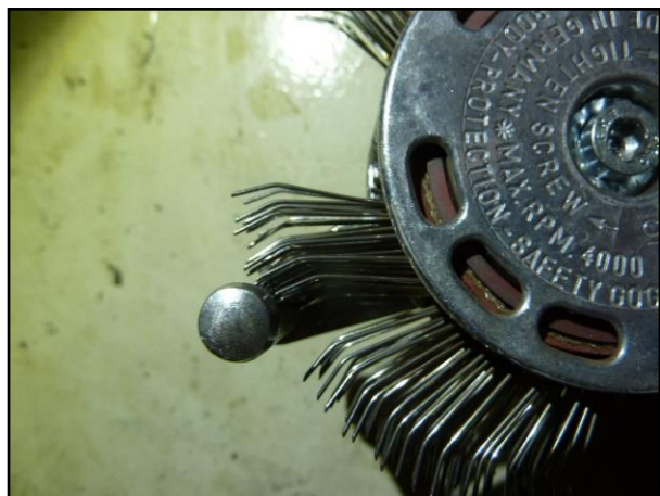
Bild 12: Abgenutztes Band am Bristle Blaster der Fa. Monti; der Spannstift kann die Drähte nicht mehr spannen [Foto: DEGES GmbH]
