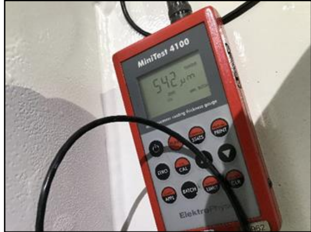
Bild 7: Die gemessene Schichtdicke von 542 µm im Bereich einer Ecke [Foto: Fa. Donges SteelTec GmbH / Darmstadt]
