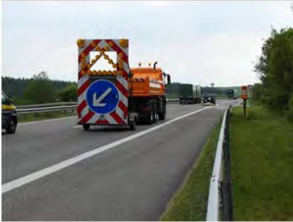
Abbildung 29: Verkehrssicherung während der Georadarmessungen (Ansicht von hinten)
