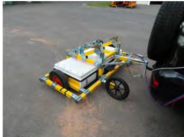
Abbildung 28: Messvorbereitung - Installation des Messanhängers mit dem Radarscanner
