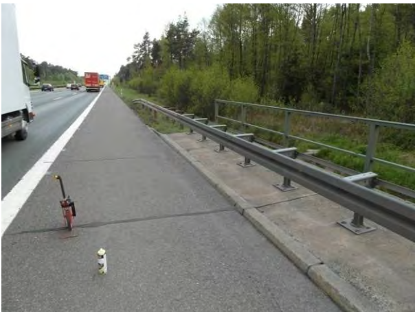
Abbildung 61: Erfassung von Abschnittsgrenzen (Querfugen an Bauwerken)
