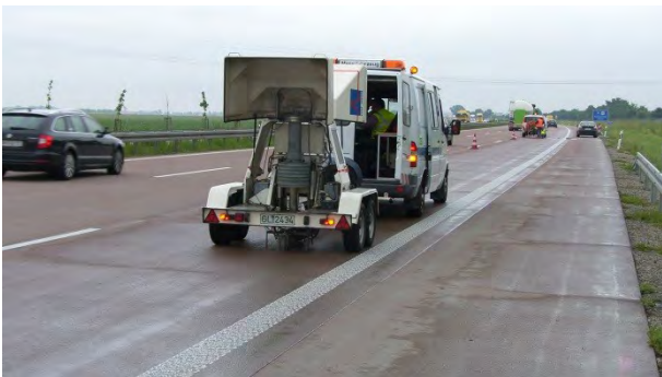
Abbildung 42: FWD-Messung in Plattenmitte des ersten Fahrstreifens (Betonbefestigung)
