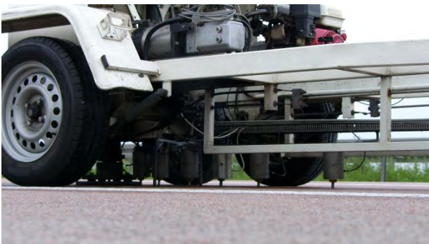
Abbildung 44: Anordnung der Geofone an Messbalken (Seitenansicht)
