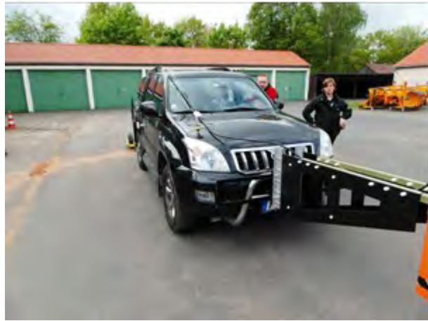
Abbildung 27: Messvorbereitung - Installation der Messtechnik im Zugfahrzeug
