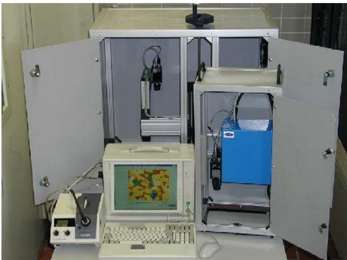
Abbildung 15: Stationäres T3D-Messsystem der BAST
