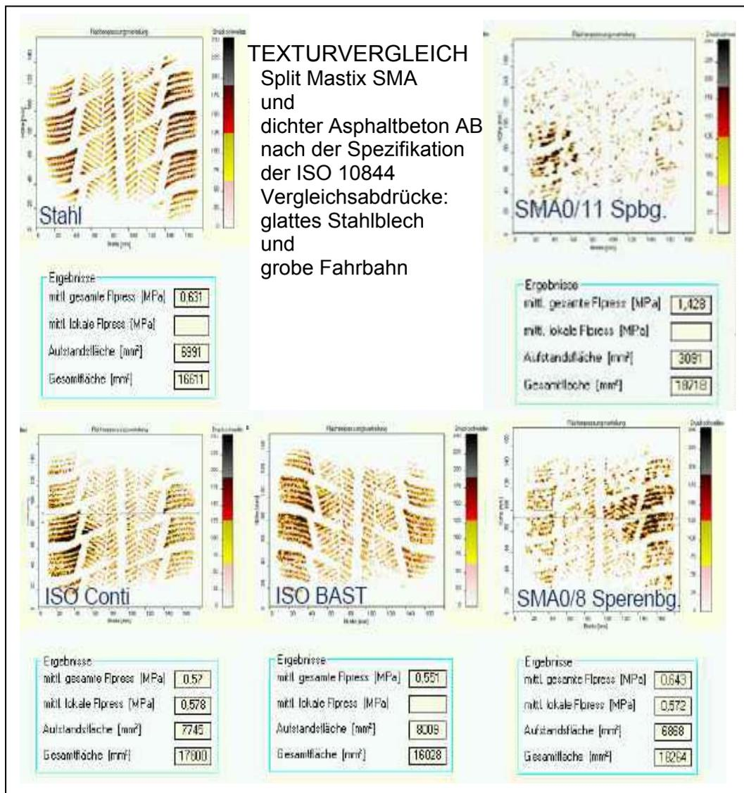
Abbildung 49: Flächenanteile der Reifenkontaktfläche bei unterschiedlichen Oberflächen
