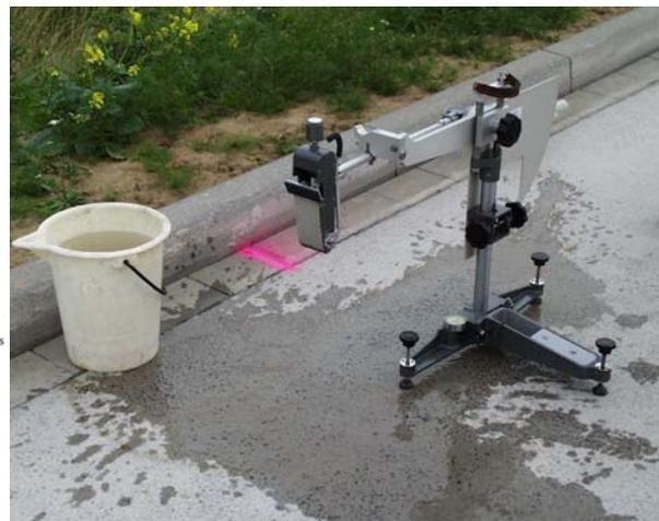
Abbildung 8: SRT-Pendelgerät in situ
