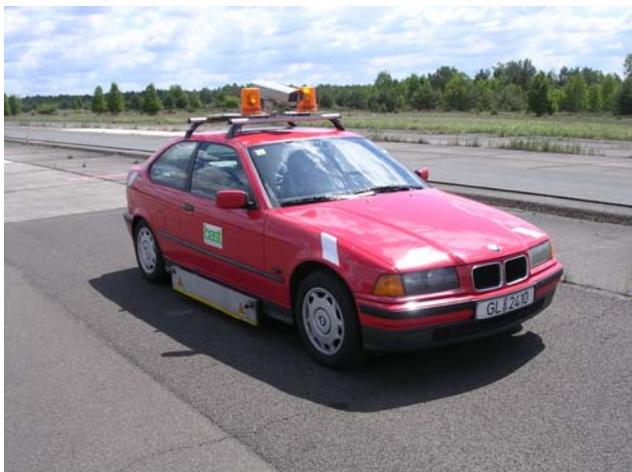
Abbildung 10: Texturmessfahrzeug TMF der BAST
