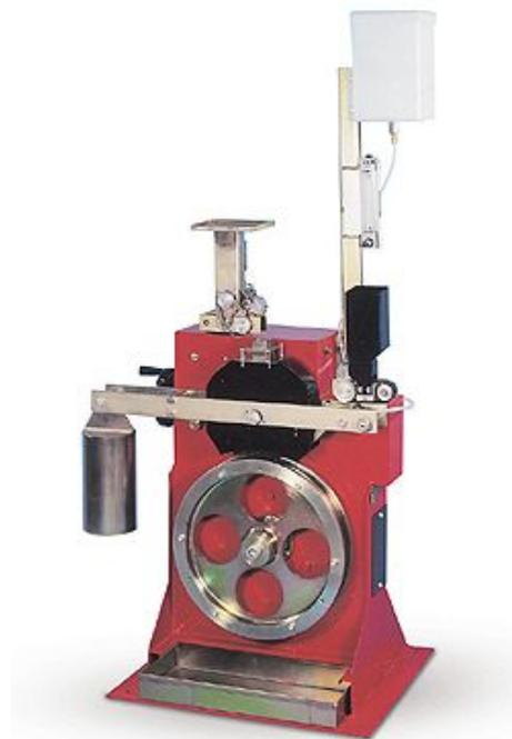
Abbildung 18: Schnellpoliermaschine PSV-Versuch
