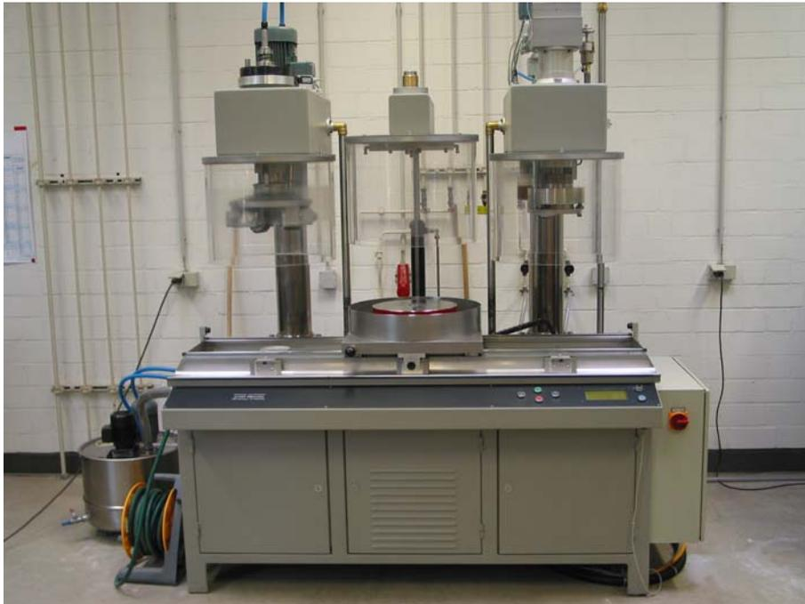
Abbildung 12: Prüfeinrichtung nach Wehner/Schulze (BAST)
