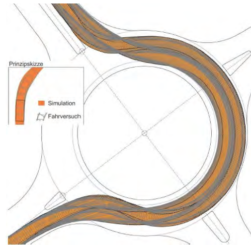
Bild 16 \frac{1}{4} Kreisdurchfahrt Vergleich Simulation - Fahrversuch, Typ 1 [FRIEDRICH U.A. 2013]
