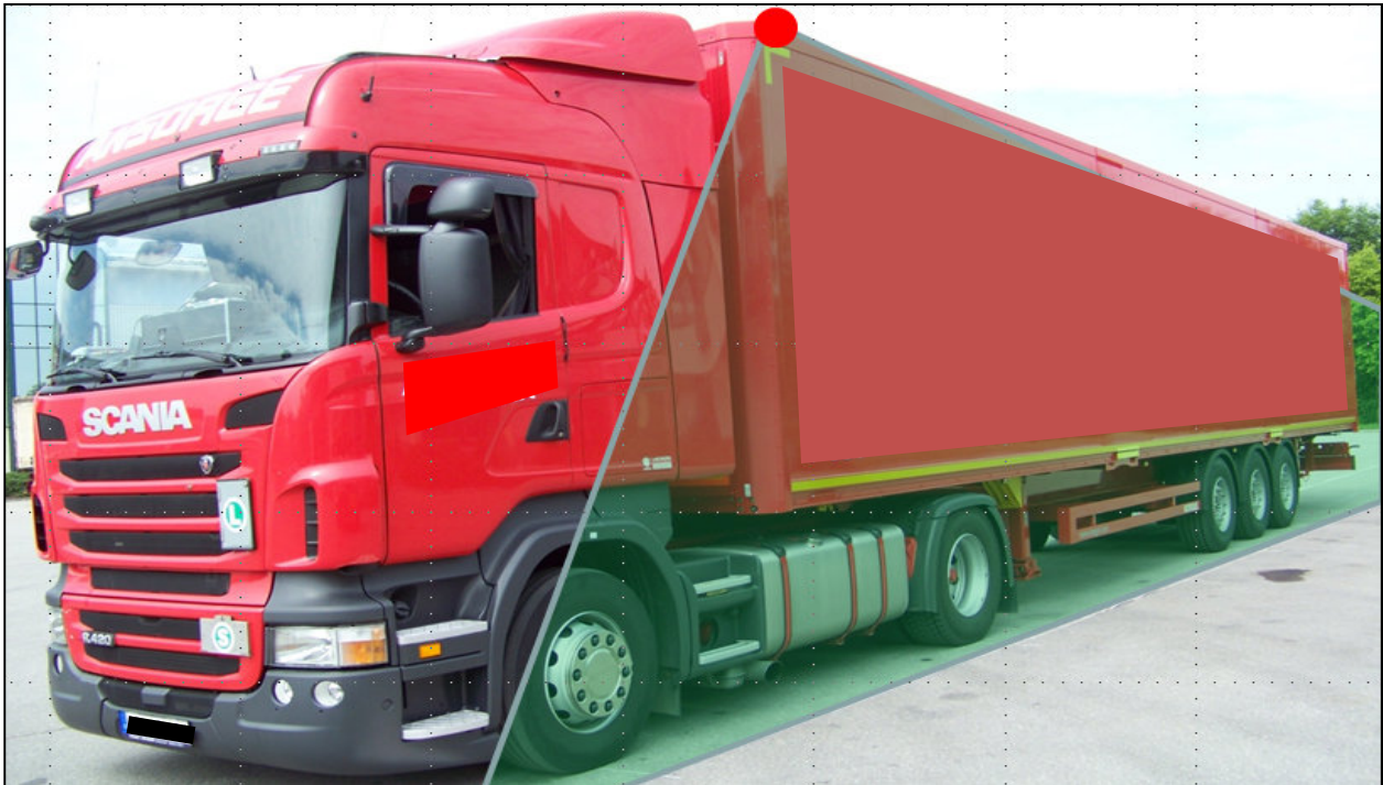
Bild 20: Lang-Lkw - Typ 1 mit erfassten Sichtbereich (grüne Fläche) der Kameras (roter Punkt)
