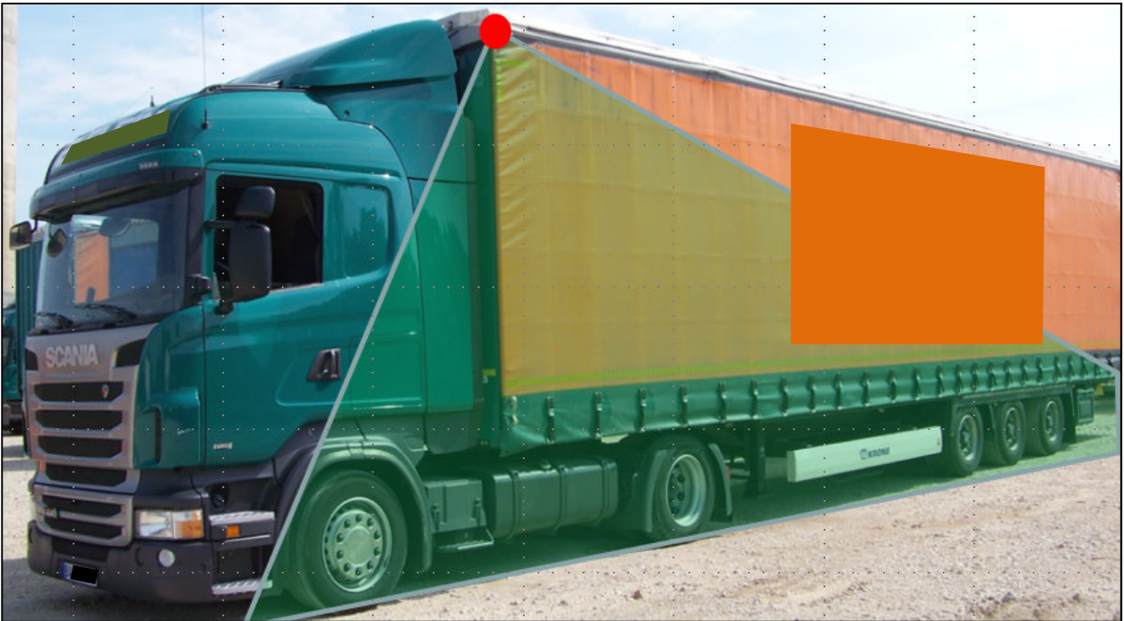
Bild 24: Referenzfahrzeug mit erfassten Sichtbereich (grüne Fläche) der Kameras (roter Punkt)
