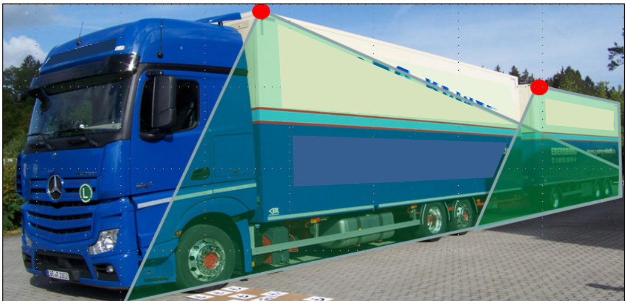
Bild 23: Lang-Lkw - Typ 5 mit erfassten Sichtbereich (grüne Fläche) der Kameras (roter Punkt)
