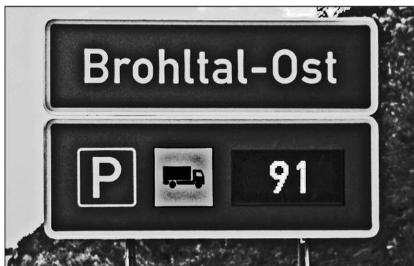
**Bild 5:** Dynamische Wegweiser vor der Rastanlage Brohltal-Ost (Foto: Landesbetrieb Mobilität Rheinland-Pfalz)
