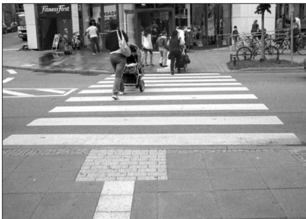
Bild 33: Minikreisverkehrszufahrt mit Aufmerksamkeitsfeld, Hinführung und Rillenplatten
