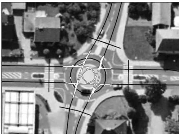
Bild 112: Netzmodell des untersuchten Minikreisverkehrs
