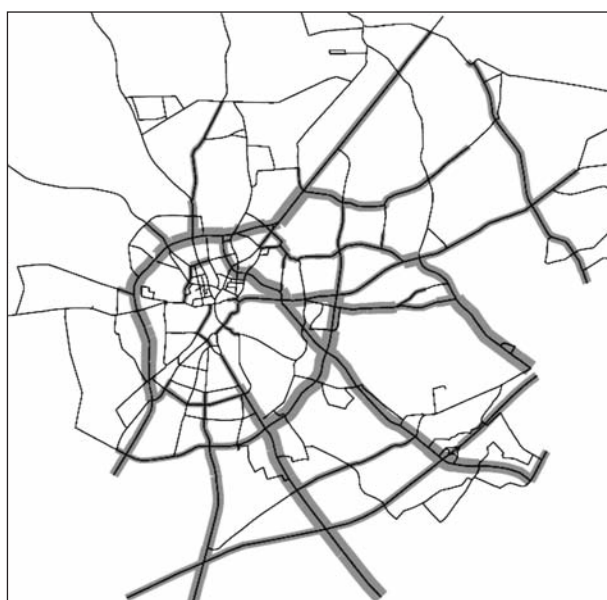
Bild 56: Differenzbild der Verkehrsbelastung für das Szenario „Pedelectrisierung“ zum Ausgangsszenario (Darstellung der Entlastungen > 1.000 Kfz/24h); Beispielstadt Gütersloh
