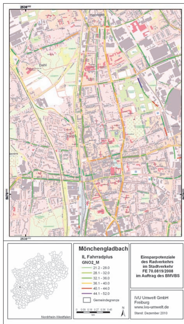
Bild 150: Ergebnis der Immissionsberechnung: NO 2 -Jahresmittelwert für das Szenario „Fahrrad Plus“ im Bereich der Friedrich-Ebert-Straße (Hotspot) in Mönchengladbach
