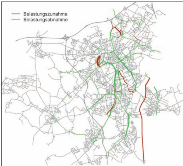
Bild 130: Differenzenbild der Verkehrsbelastung für das Szenario „bewusste Mobilität +“ zum Ausgangsszenario (Darstellung der Veränderung > 100 Kfz/24h); Beispielstadt Mönchengladbach
