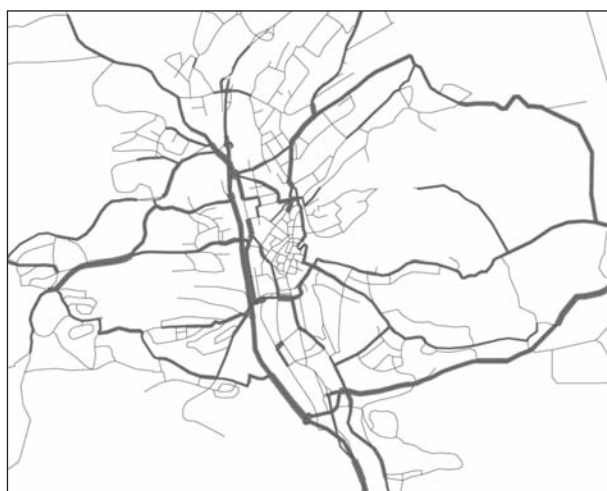
Bild 88: Differenzbild der Verkehrsbelastung für das Szenario „Pedelectrisierung am Berg“ zum Ausgangsszenario (Darstellung der Veränderung > 250 Kfz/24h); Beispielstadt Coburg
