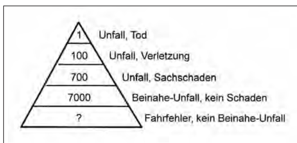
Bild 6: Relative Häufigkeit und Schwere von Unfällen und Beinahe-Unfällen: „Heinrichs Dreieck“ (zit. n. HOLLNAGEL, 2004, S. 24). Die relativen Häufigkeiten der drei obersten Zeilen sind Näherungen der Zahlen im deutschen Straßenverkehr 2011
