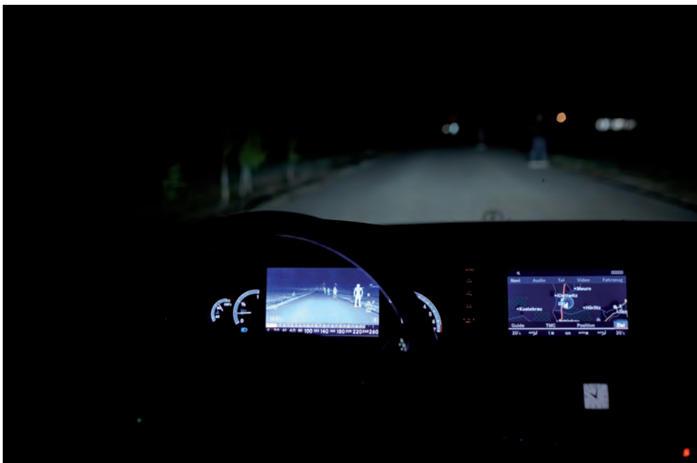
Fahrzeug mit Nachtsicht-assistent (Foto: Deutscher Verkehrssicherheitsrat e.V.)
