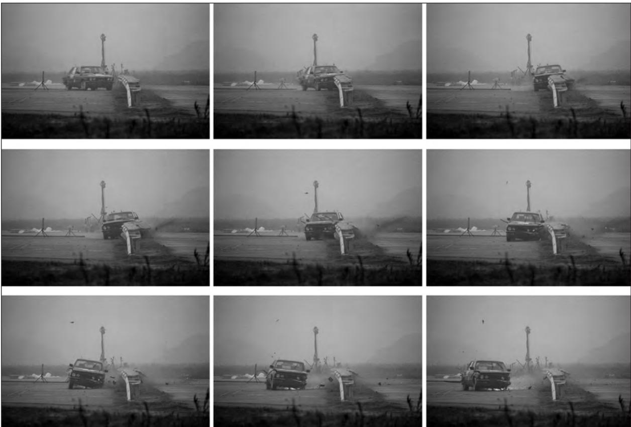
Bild 9: Anprallprüfung TB 32 an einer EuskirchenPlus-EDSP
