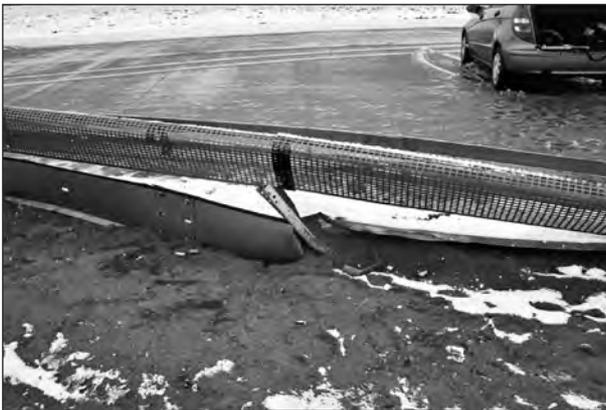
**Bild 13:** Rückwärtige Ansicht am Stoß 7/8 nach Anprallversuch
