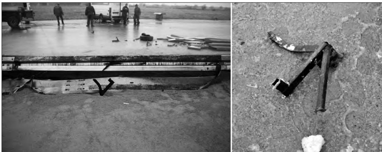
**Bild 14:** Links: Ansicht Vorderseite Holm Nr. 7, nach Anprallversuch. Vor dem Unterzug ist deutlich der Führungszapfen des Fahrzeugs zu erkennen. Rechts: deformierter Führungszapfen
