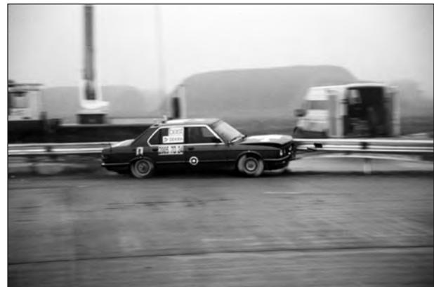
Bild 10: Anprallprüfung TB 32 an einer EuskirchenPlus-EDSP, Pkw überrollt Unterfahrerschutz
