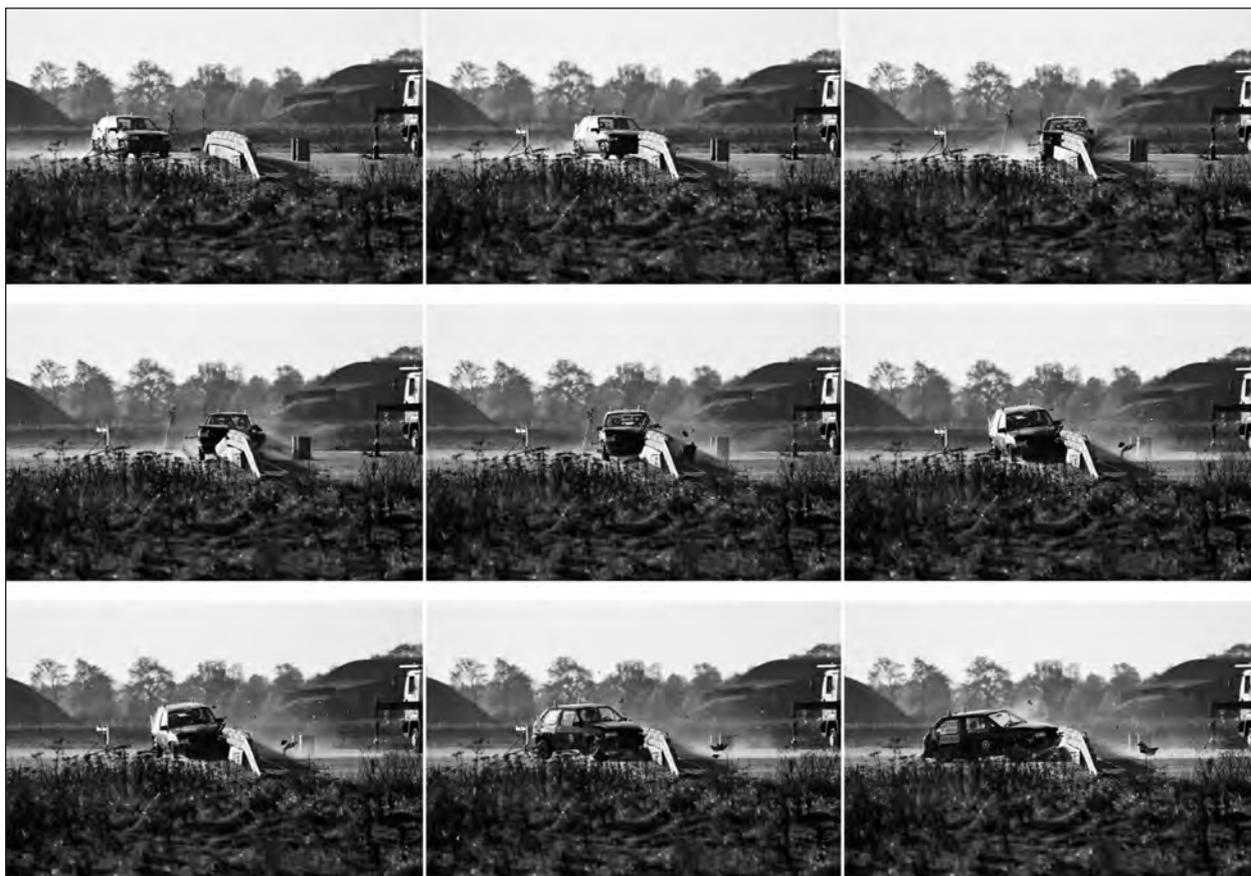
**Bild 19:** Anprallprüfung TB 11 an einer ESP-Motorrad
