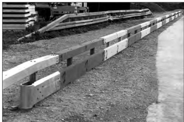
**Bild 3:** Prototyp einer Schutzeinrichtung mit verringertem Verletzungsrisiko für Motorradfahrer „Kastenprofil mit Unterfahrerschutz“ nach [BÜRKLE]
