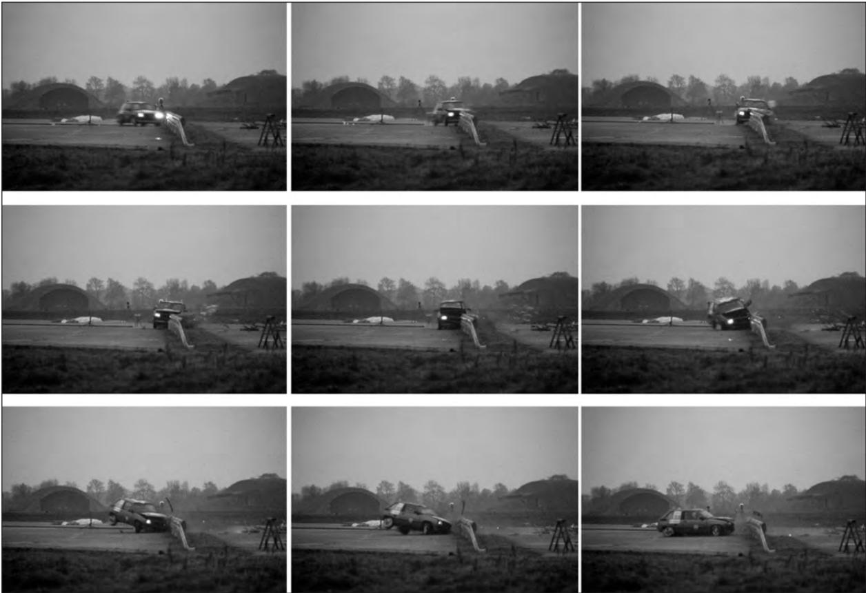
**Bild 12:** Anprallprüfung TB 11 an einer EuskirchenPlus-ESP
