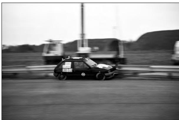
**Bild 8:** Anprallprüfung TB 11 an einer EuskirchenPlus-EDSP, Pkw fährt auf Unterfahrerschutz auf
