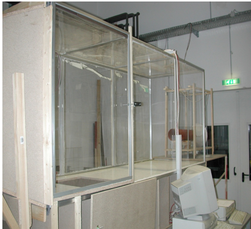
Bild 8 Fotografie des Pflanzenaufnahmesegementes des für einen Volumenstrom von maximal 20.000 \text{ m}^3/\text{h} ausgelegten Windkanals der Querschnittsfläche von ca. 1 \text{ m}^2 .
