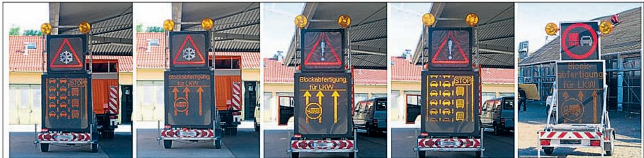
Bild 32: Programmierungsvarianten der realen LED-Vorwarmer zum Einsatz bei der Blockabfertigung
