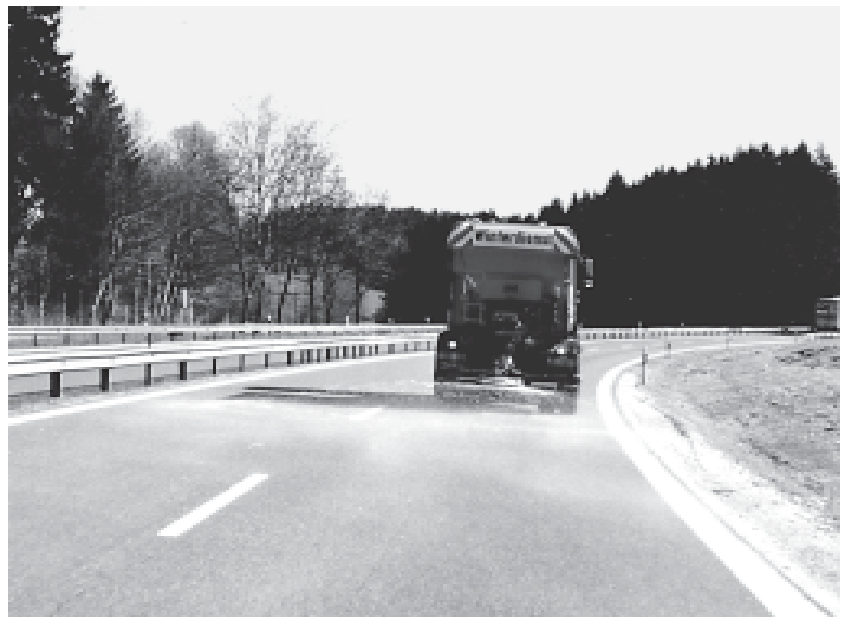
Streumaschine im Einsatz
