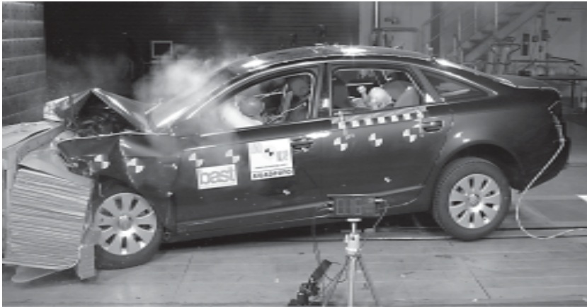
Euro NCAP Frontaltest mit 40 % Frontüberdeckung und 64 km/h Aufprallgeschwindigkeit gegen eine deformierbare Barriere (Foto: Uwe Freier)
