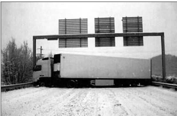
Bild 3.2-4: Konsequenz bei Verwendung von Antriebsachsreifen ohne ausreichende Traktion
