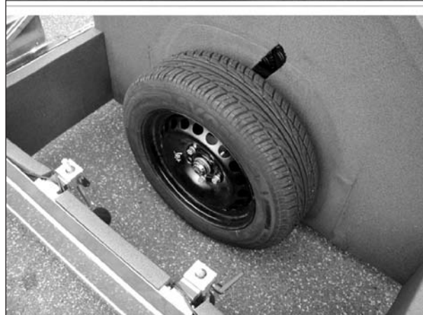
Bild 5-2: CPX-Anhänger der BAST (links) – Messrad und Mikrofone (rechts) [14]
