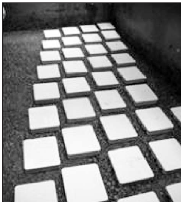
Bild 4.5.20: Eingebaute Resonatorelemente im Prüfstand
