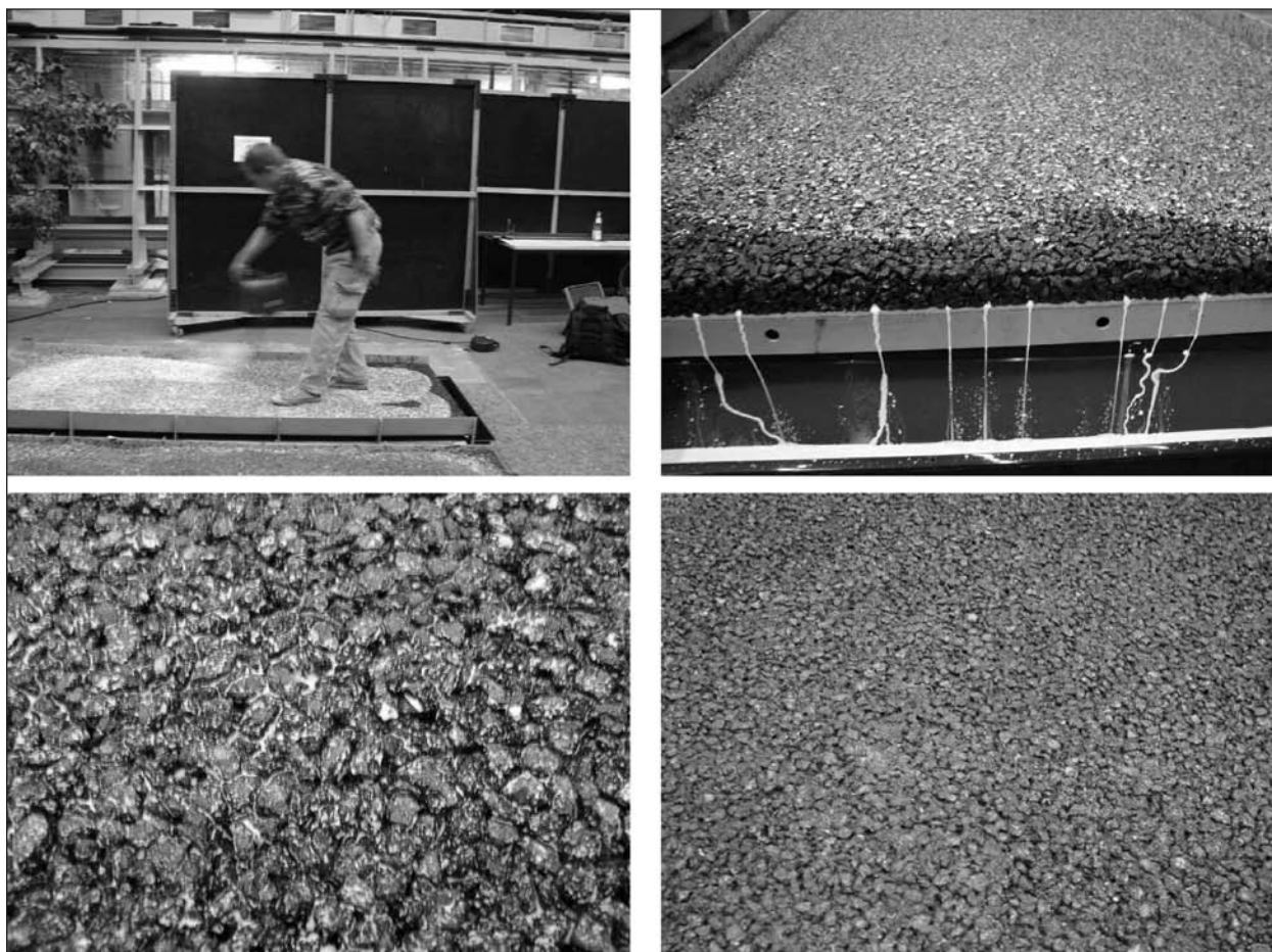
Bild 4.2-28: Händisches Aufgießen der Beschichtung (links oben), Abfließen der überschüssigen Beschichtung aus dem OPA 0/11 (rechts oben), ZWOPA 0/8_0/16 unmittelbar nach Beschichtungsauftrag (links unten) und nach Einsickern und Abtrocknen der Beschichtung (rechts unten)
