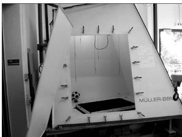
Bild 4.5-15: In die Hallkabinen eingebauter Probekörper
