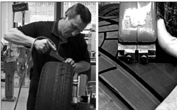
Bild 3-3: Herstellung von Schnitzreifen für die Reifenentwicklung
