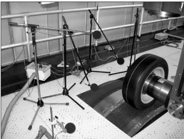
Bild 3.4-11: Reifenprüfstand im Continental-Labor
