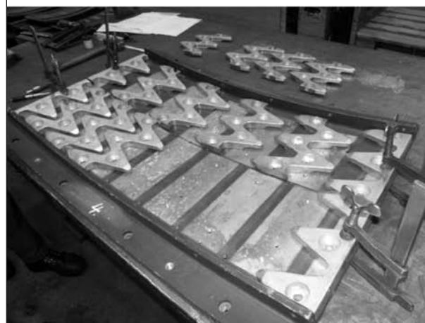
Bild 4.6.1-26: Kassette als Adapter für den Großversuchsstand und bestückte Kassette (hier mit stählernen Lärmschutzelementen)
