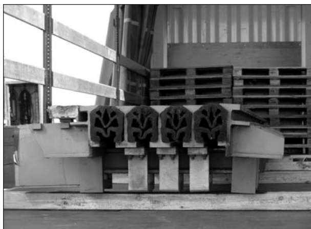
Bild 4.6.1-11: Dämpfung durch Fugen füllende Dichtprofile aus LeiStra 1
