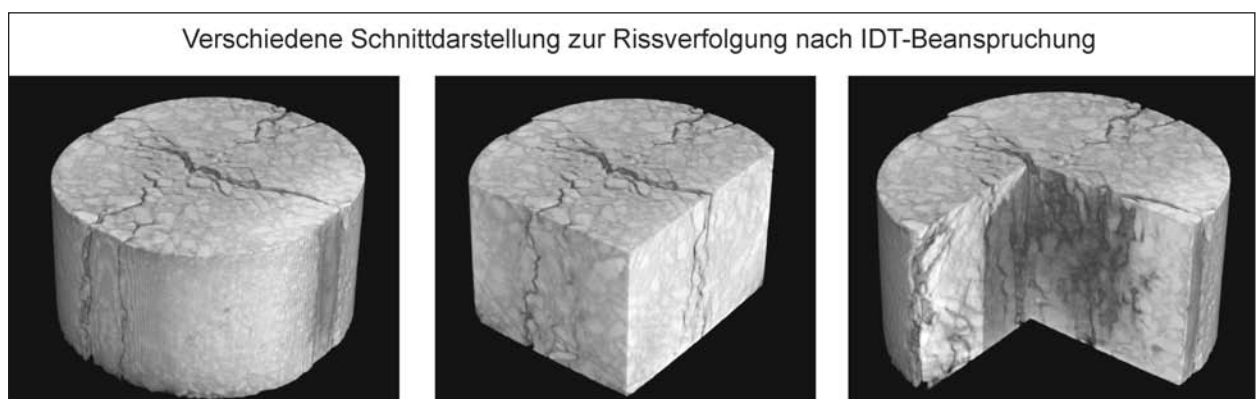
Bild 4.3-19: Detailaufklärung von Rissverläufen
