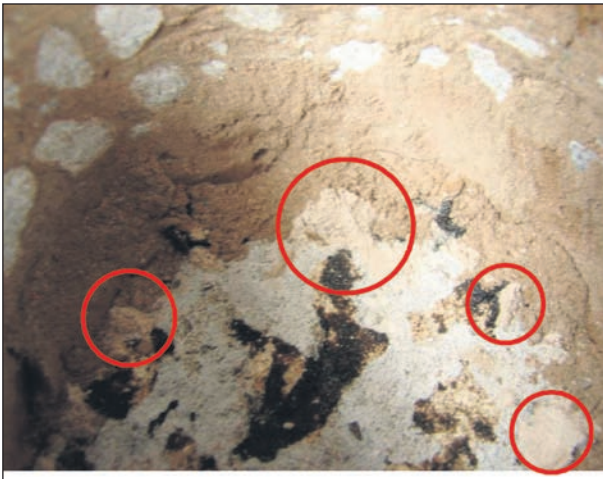
Bild 4.3-26: Ansammlungen von Schmutzpartikeln auf der Probenunterlage
