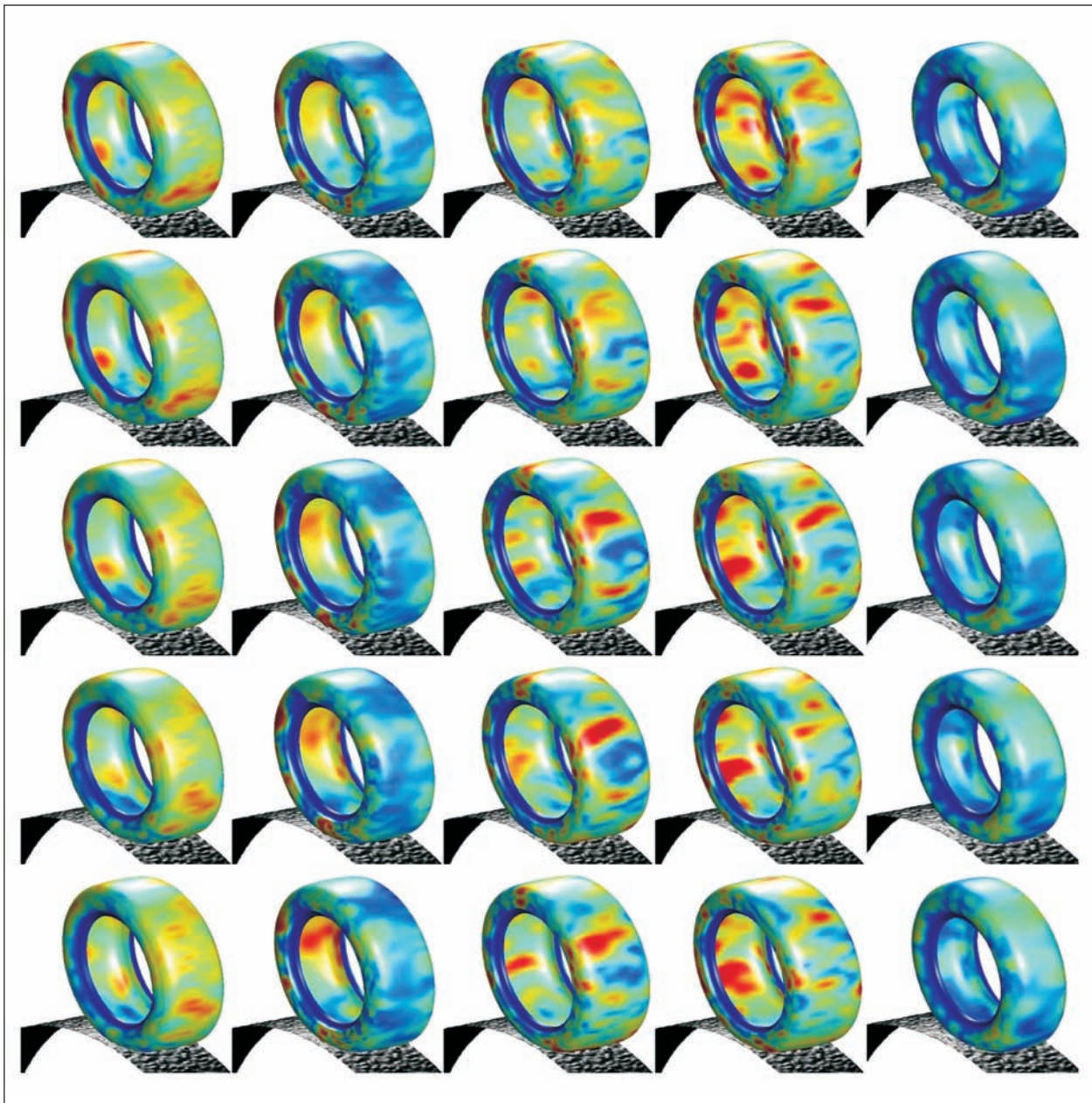
Bild 3.4-36: Betriebsschwingungen bei 100 km/h auf der Trommel mit Mira-Textur, Referenz, Komplementär, Sommer, Winter, Klein. Zeitverlauf von oben nach unten mit Schrittweite 0,42 ms. Rot in der Farbskala entspricht 0,5 mm, effektive Amplitude
