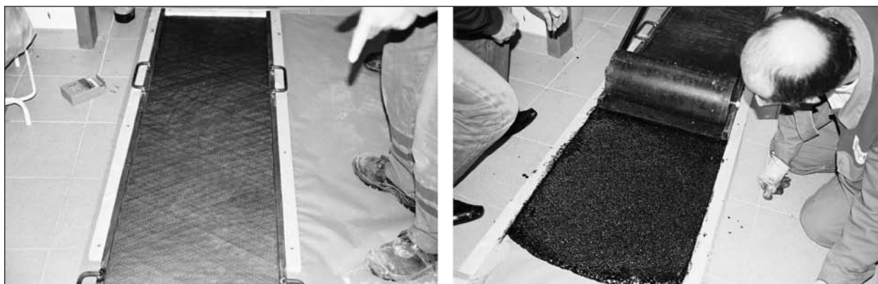
Bild 1-8: Herstellung des „ITARI-Belags“ im Labor [1]
