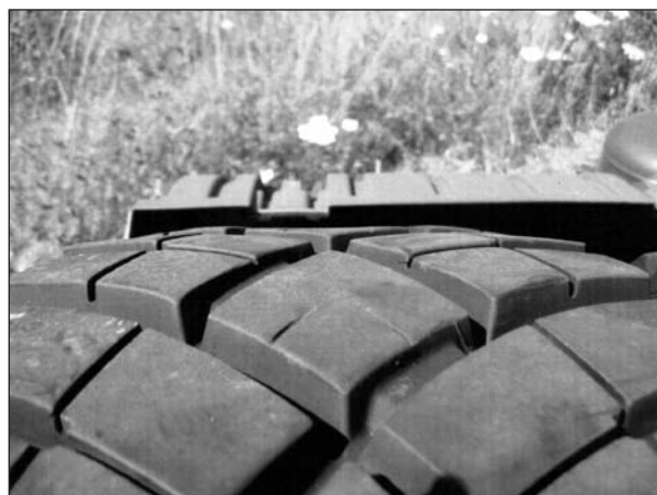
Bild 3.2-38: Reifenabrieb mit Sägezahnausbildung
