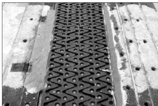
Bild 4.6.1-5: Versuchskörper Dämpfung der Wirkung dynamischer Belastung
