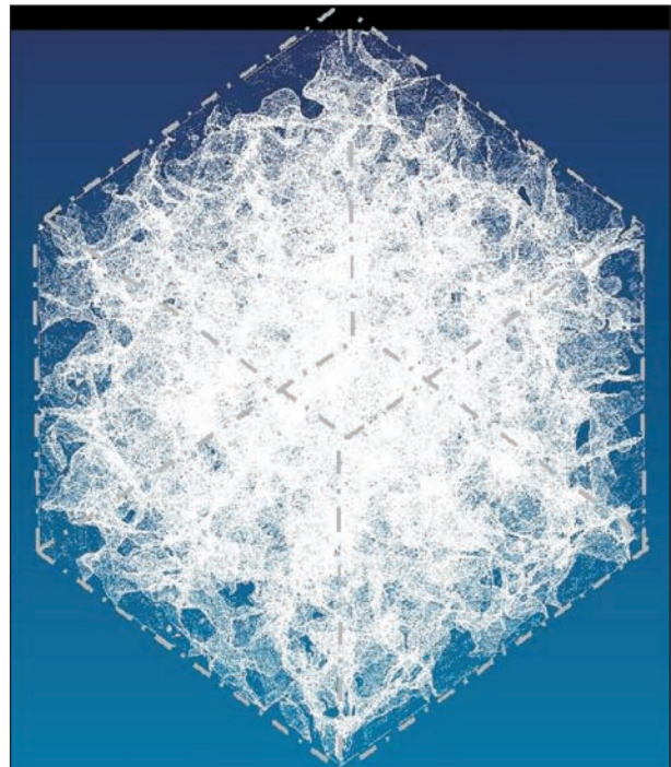
Bild 4.3-28: FEM-Modellierung der Hohlraumstruktur eines OPA-Probekörpers
