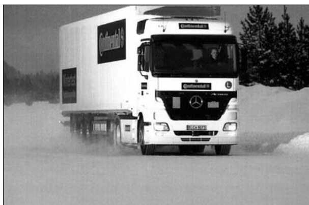
Bild 3.2.44: Winterfahrversuch, Ermittlung der Schneextraktion
