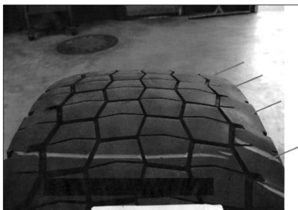
Bild 3.2-37: Periodischer Abrieb durch Einsatz der Retarder-Bremse
