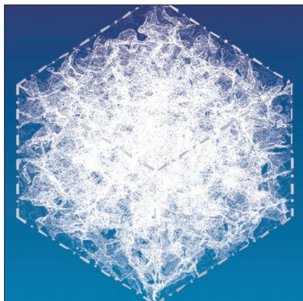
Bild 4.3-9: Beispielhafte Darstellung der reproduzierten Hohlraumstruktur für einen Ausschnitt von 30 x 30 x 30 mm eines Offenporigen Asphalt
