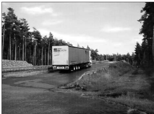
Bild 3.2.43: Rampenauffahrt zur Bestimmung der Traktion am Berg
