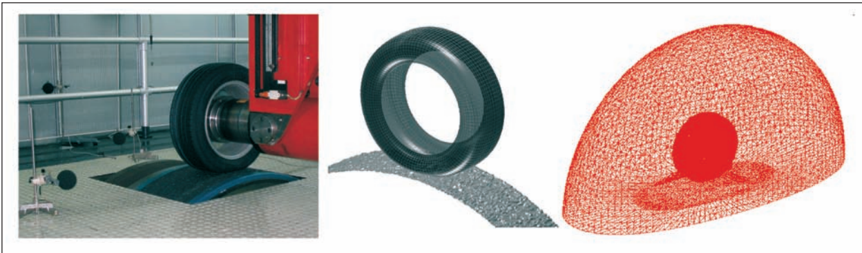
Bild 3.5-9: Rollenprüfstand der Continental AG (links), diskretisierter Reifen mit Fahrbahntextur (Mitte) und akustisches Modell mit finiten/infiniten Elementen (rechts)
