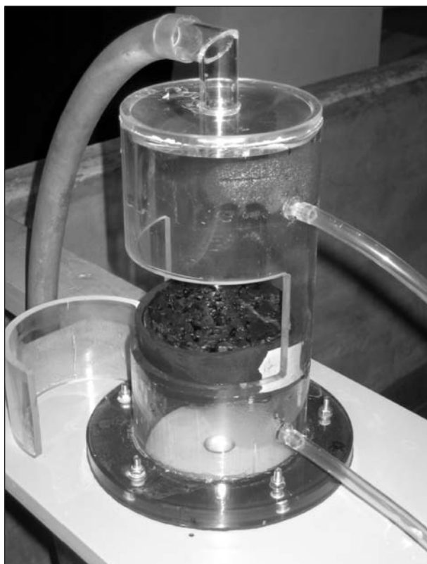
Bild 4.4-1: Versuchsaufbau nach DARCY zur Ermittlung der Durchlässigkeitsparameter von porösen Asphalten. Die Probe wird mittels einer aufblasbaren Gummidichtung fixiert und abgedichtet
