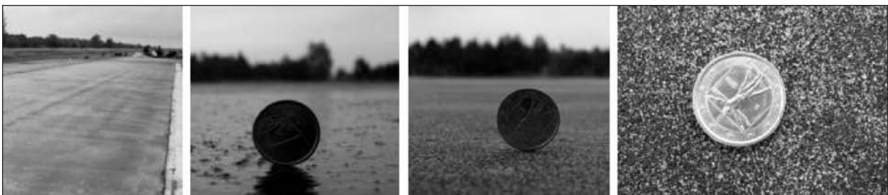
Bild 4.5-31: Aufnahmen der hergestellten Gussasphaltschicht
