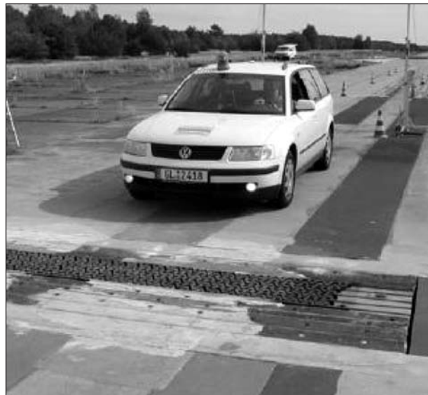
Bild 4.6.1-18: Testfeld B17 mit vorbereitetem Fahrbahnübergang/dämpfende Abdeckung
