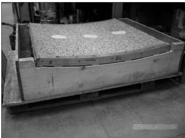
Bild 5-10: Prüfkassetten mit Waschbeton 0/8 für Untersuchung im Prüfstand Fahrzeug/Fahrbahn
