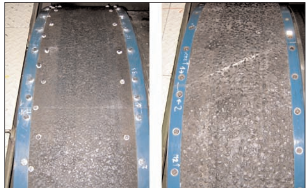
Bild 3.4-7: Trommeltexturen, links: Glattasphalt, rechts: Mira-Textur
