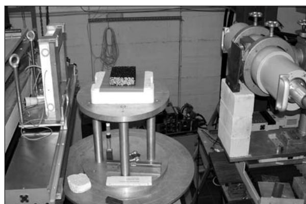
Bild 4.3-5: Messkonfiguration zur Untersuchung größerer Proben bis zu einer Diagonale von maximal 50 cm (Makro-CT-Anlage mit 450-kV-Röntgenstrahler)
