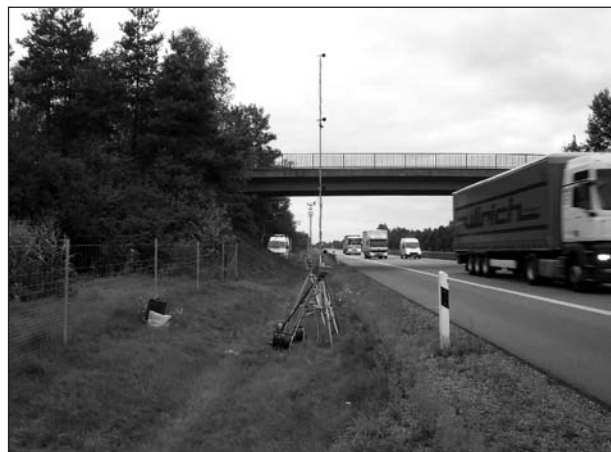
Bild 5-1: Messaufbau der Statistischen-Vorbeifahrt-Methode
