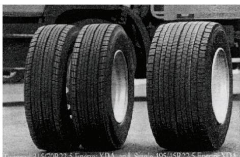
Bild 9: Mögliche neue Fahrzeugkonfigurationen und "Footprints" für einen Super Single Reifen vom Typ 495/45 R22.5
