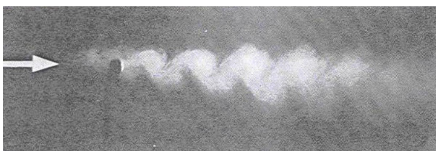
Abbildung 1: Wirbelstraße hinter einem Zylinder [1]
