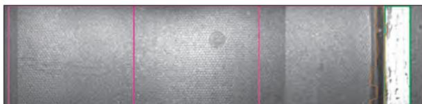
**Bild 49:** Untersegmentierung. Die feinen Querrisse auf der linken Seite wurden nicht detektiert
