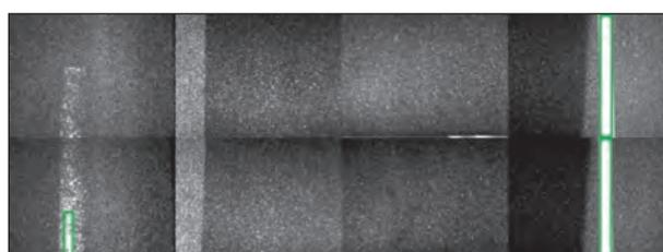
**Bild 39:** Die stark abgefahrene Fahrbahnmarkierung am linken Rand des Bildes kann nicht detektiert werden
