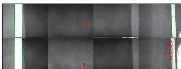
**Bild 40:** Fehldetektionen der Fahrbahnmarkierungen können zur Übersegmentierung bei der Merkmalsdetektion führen. Im Bild rechts unten wurde keine Fahrbahnmarkierung detektiert, es kommt zu Merkmals-Fehldetektionen am Fahrbahnrand (rot)
