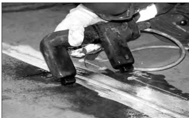
**Bild 101:** Magnetpulverprüfung der Instandsetzung
