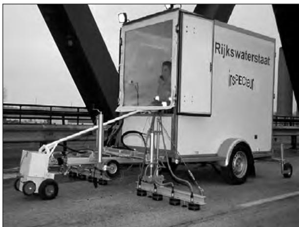
**Bild 66:** CrackPec' – Verfahren zur gleichzeitigen Überprüfung von 8 Stellen
