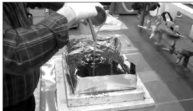
**Bild 133:** Probekörperherstellung: Verfüllung des hohlraumreichen Asphaltträgergerüsts mit flexibilisiertem Epoxidharz (HANV)
