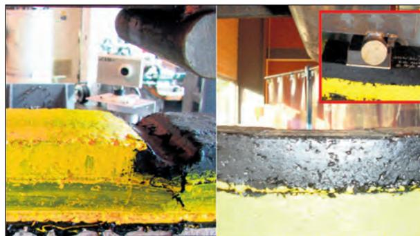
**Bild 137:** Einfluss unterschiedlicher Lasteinleitungsflächen auf Verformungen der Asphaltoberfläche (links: Linienlast; rechts: vergrößerte Lasteinleitungsfläche)
