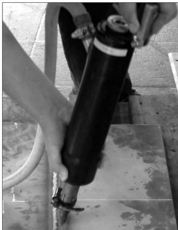
Bild 62: Anwendung des UIT-Verfahrens
