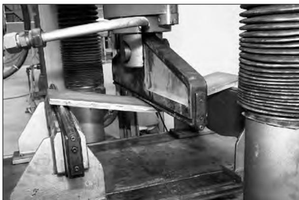
Bild 115: Probekörper bei der Biegeprüfung
