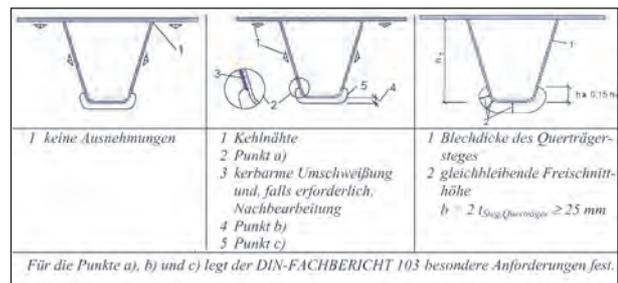
**Bild 10:** Detailanforderungen an die Verbindung Längsrippe – Querträger
