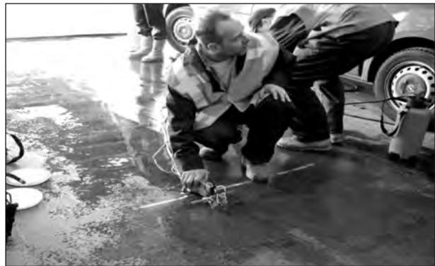
**Bild 97:** Ultraschallprüfung auf mögliche Deckblechrisse
