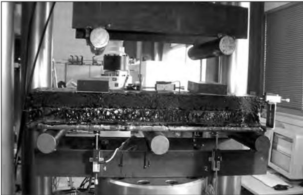
**Bild 138:** Zusätzliche Prüfkörper mit Wegaufnehmern im Feld, über der Stütze und am Belagsrand
