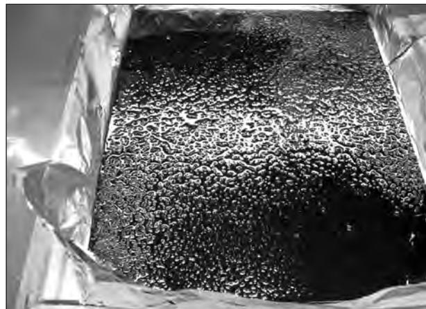
**Bild 134:** Fertiger Probekörper: hohlraumreiches Asphaltträgergerüst mit flexibilisiertem Epoxidharz (HANV)
