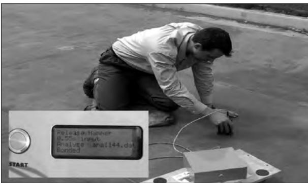
**Bild 88:** Prüfung des Injektionserfolges
