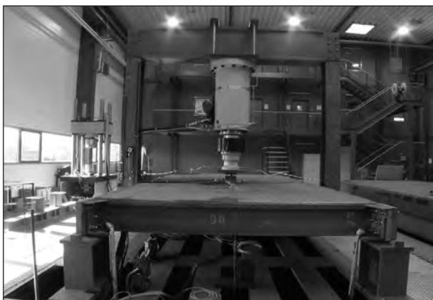
**Bild 79:** Statische Belastung zur Untersuchung der Wirkung der Verstärkung mit SPS-Auflegetechnik
