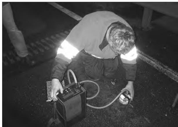
**Bild 65:** ‚CrackPec‘ – Handverfahren
