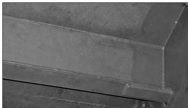
Bild 18: Schäden der Kategorie 1: Risse in der Verbindungsnaht zwischen Deckblech und Längsrippe – Sektkelchprofil
