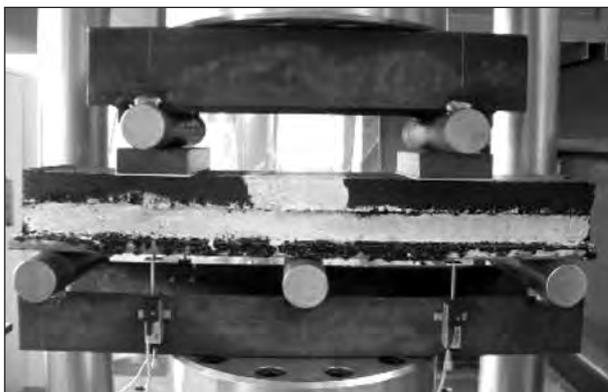
**Bild 126:** Prüfkörper und Lasteinleitung für die Systemuntersuchungen
