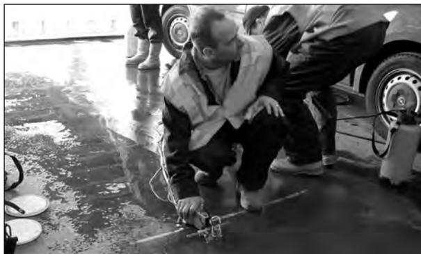
**Bild 69:** Anwendung 'TOFD'-Verfahren
