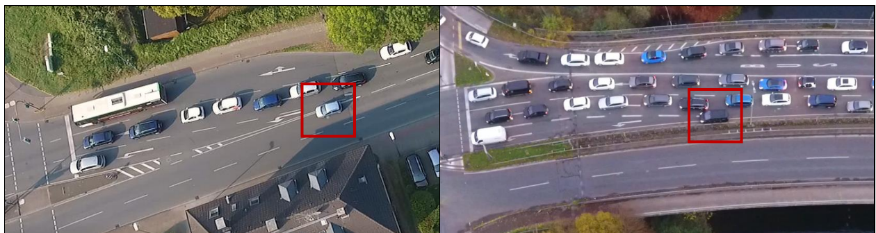
Bild 4-28: Exemplarische Darstellung von regelwidrigem Fahrverhalten an Fahrstreifen mit zusätzlichem kurzem Aufstellstreifen (links: C-2; rechts C-3)
