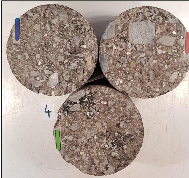
Bild A-0-7: Bildaufnahmen der ausgewerteten Bohrkern-Schnittflächen der B3
