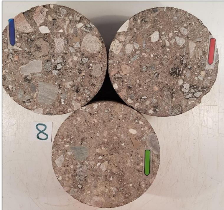
Bild A-0-11: Bildaufnahmen der ausgewerteten Bohrkern-Schnittflächen der L205
