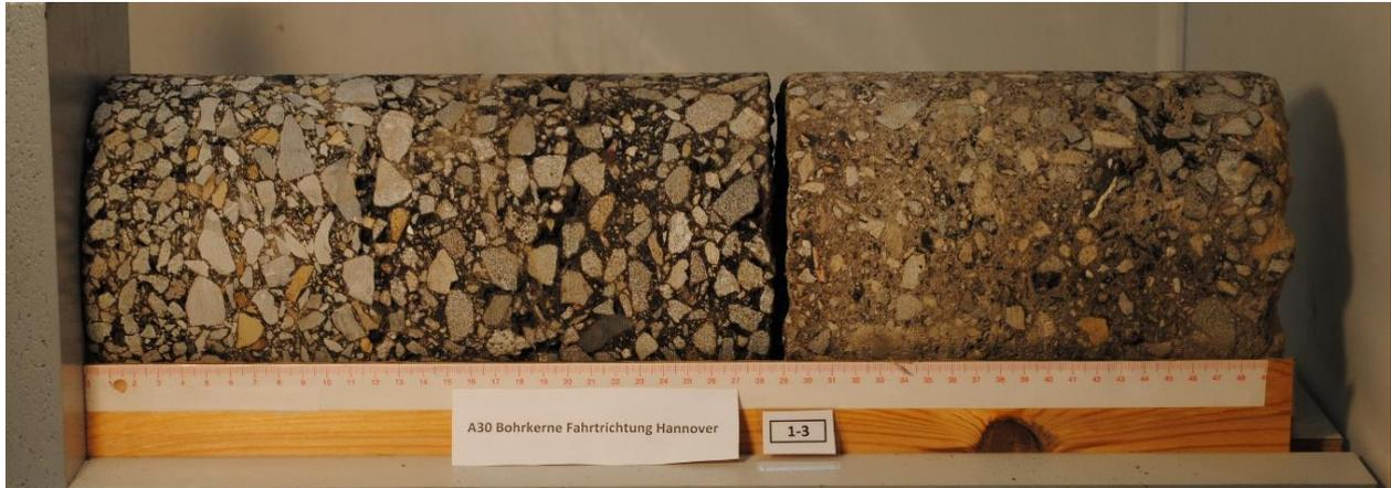
Bild 4-19: Bohrkern 1-3 der Strecke A30 FR Osten (Hannover)
