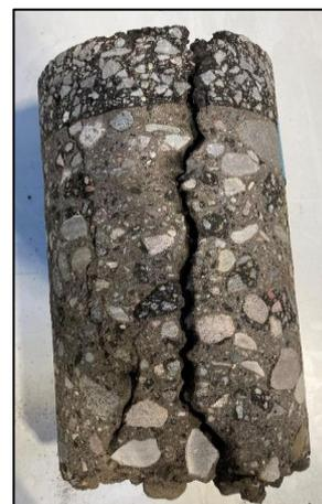
Bild 4-13: Fotodokumentation Querriss (links) und Rissbild im Bohrkern (rechts)
