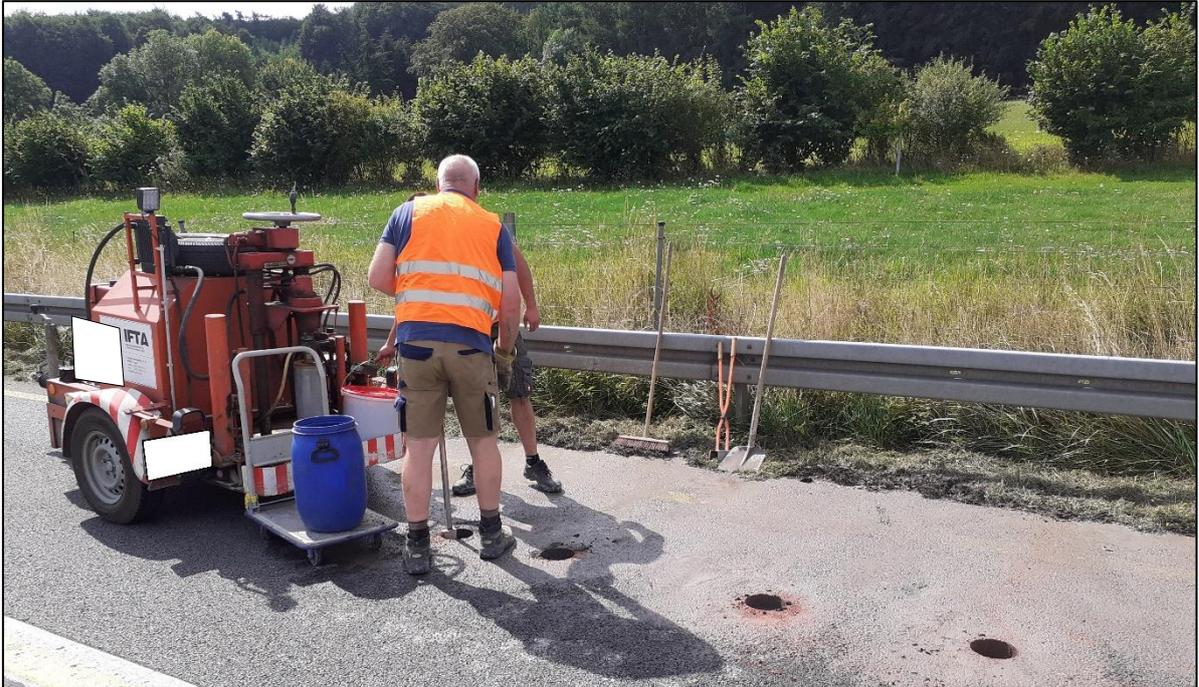
Bild 4-2: Probenentnahme im Standstreifen auf der A30 FR Osten bei km 86,75
