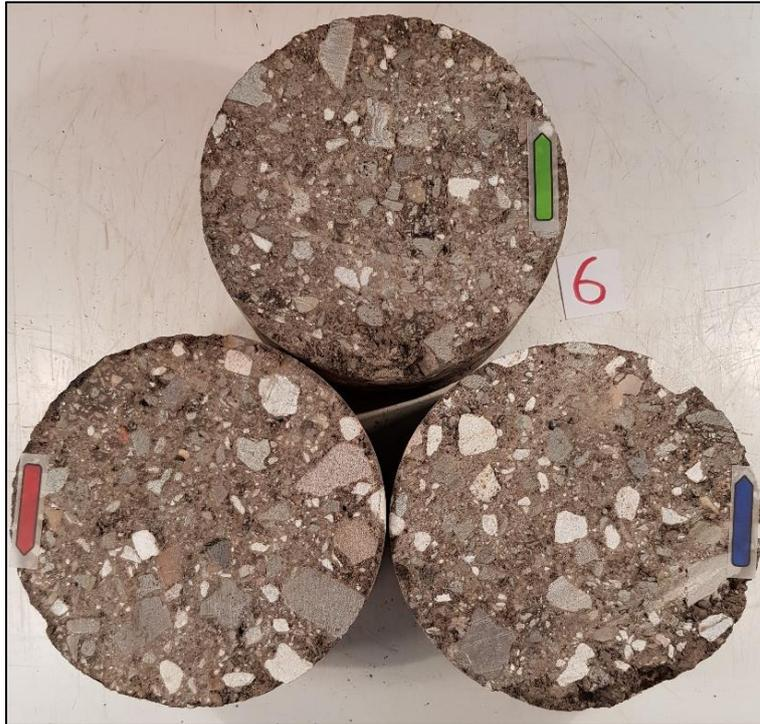
Bild A-0-9: Bildaufnahmen der ausgewerteten Bohrkern-Schnittflächen der L48
