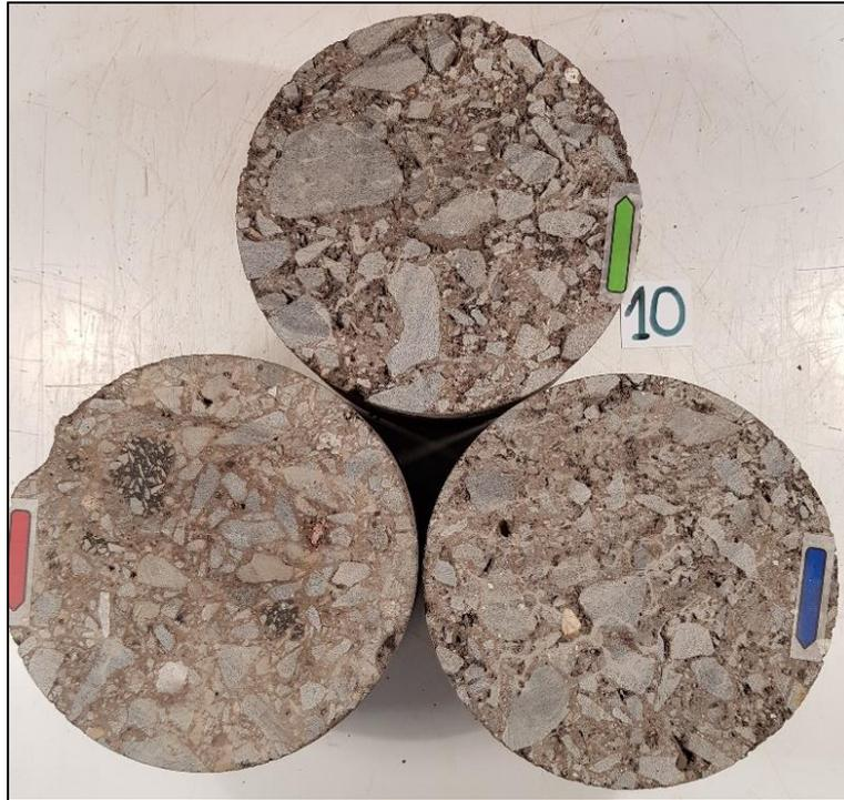
Bild A-0-13: Bildaufnahmen der ausgewerteten Bohrkern-Schnittflächen der L3400
