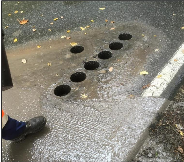
Bild 4-16: Bohrkernentnahme inner- und außerhalb der Rollspur auf der L3400 bei km 0,975
