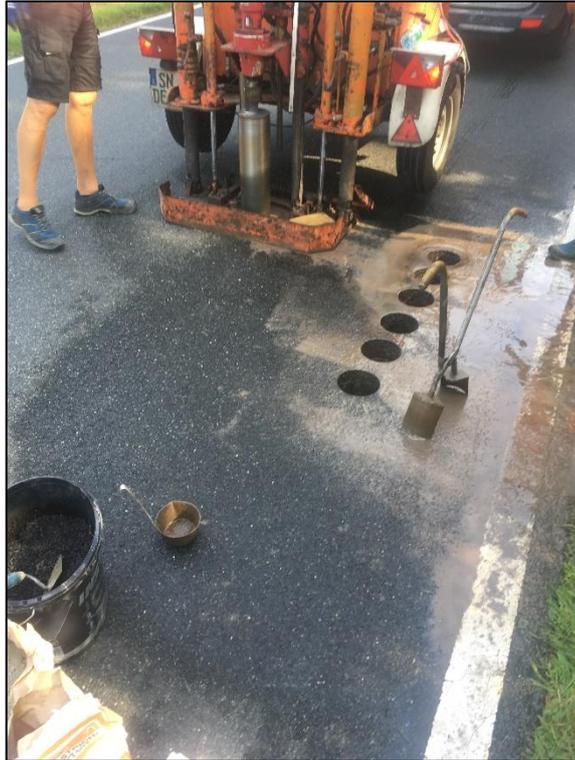
Bild 4-12: Probenentnahmestelle inner- und außerhalb der Rollspur auf der L205 bei km 7,410
