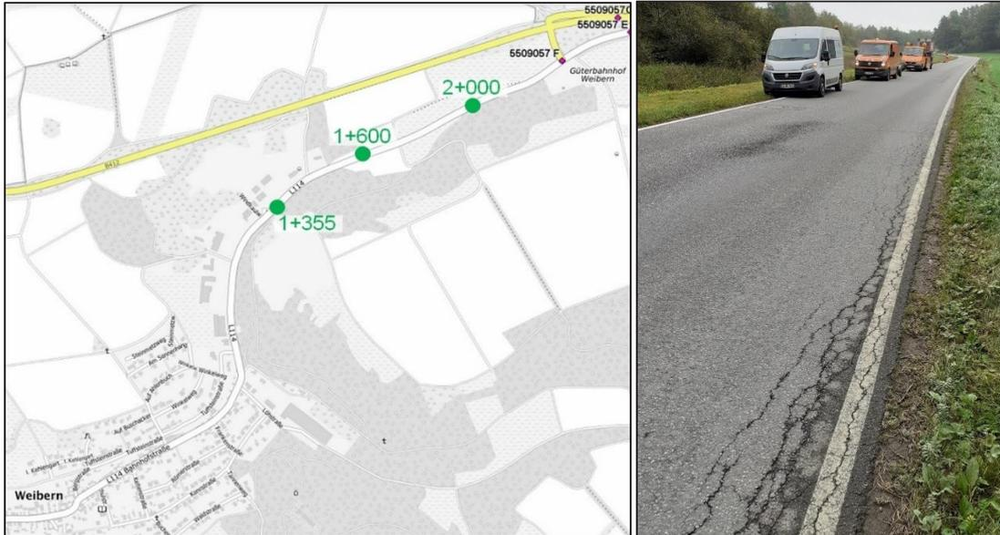
Bild 4-10: Kartenausschnitt der L114 mit Markierung der Entnahmestellen (links) und Foto der Entnahmestelle bei km 0,935 (rechts)
