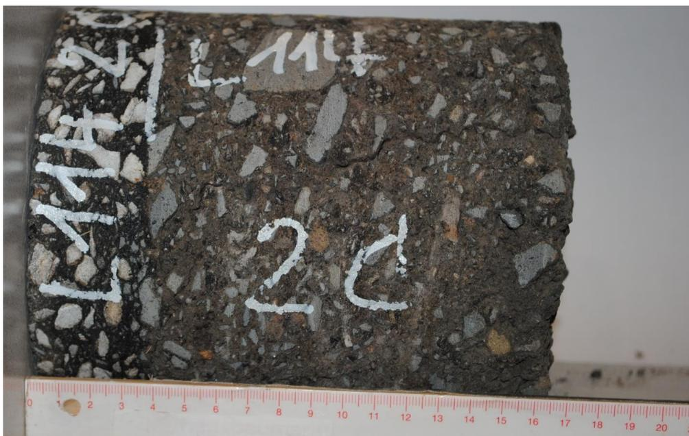
Bild 4-27: Bohrkern 2-C der Strecke L114 mit Riss
