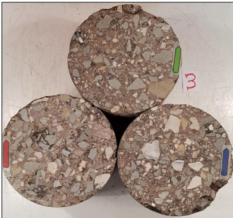
Bild A-0-6: Bildaufnahmen der ausgewerteten Bohrkern-Schnittflächen der B52
