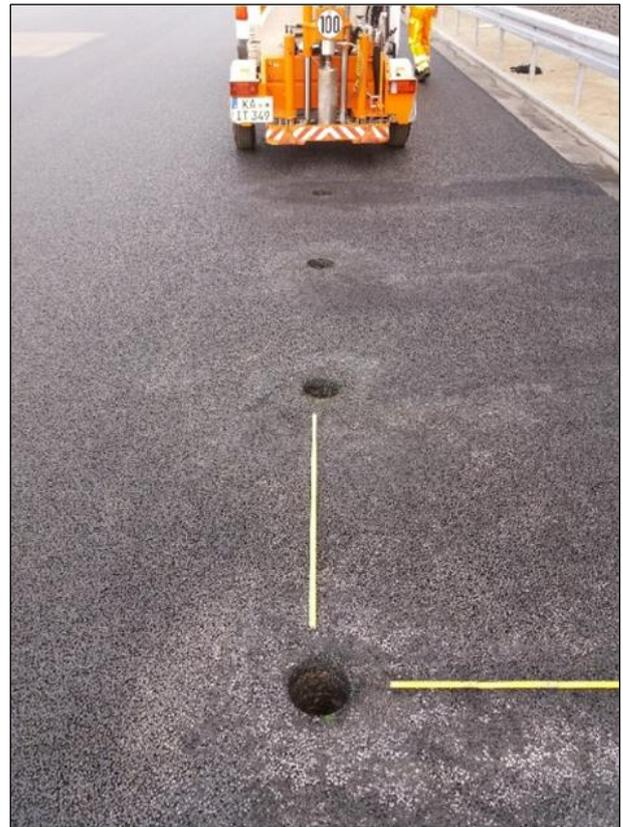
Bild 11: Bohrkernentnahme
