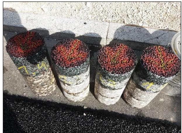
Bild 12: Bohrkern einer Untersuchungsstrecke
