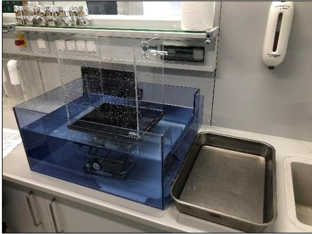
Bild 13: Grundaufbau Wasserdurchlässigkeit
