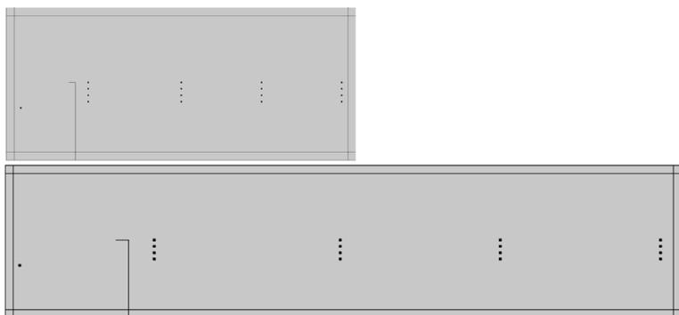
**Bild 3-12: 2D-FEM-Simulationsmodell; Quell-Empfänger-Geometrie am Beispiel einer einfach geknickten Lsw; Seitenansicht; oben: Einfallswinkel  $0^\circ$ ; unten: Einfallswinkel  $60^\circ$**
