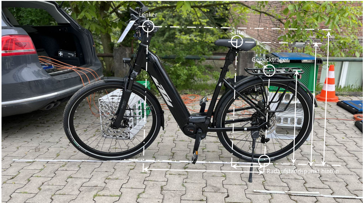
Bild 5: Referenzpunkte für die Messung von Lenker, Sattel und Gepäckträger
