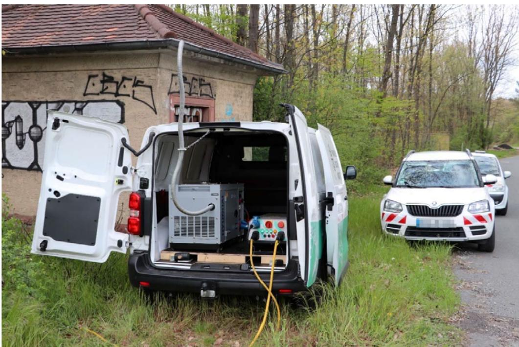
Betriebsfahrzeug der Bekämpfungsfirma mit Stromgenerator und Spannungswandler
