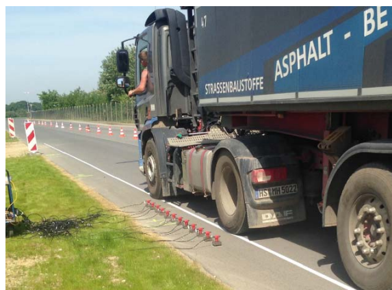
Bild 2-2: Darstellung des Messprinzips der Tragfähigkeitsmessung anhand von Geophonen
