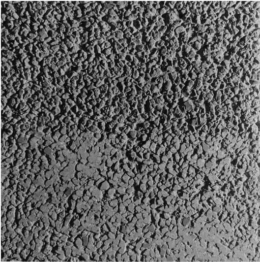
Bild 8: Laborplatte mit geschliffener unterer Hälfte und insgesamt gleichmäßigerer Texturausprägung
