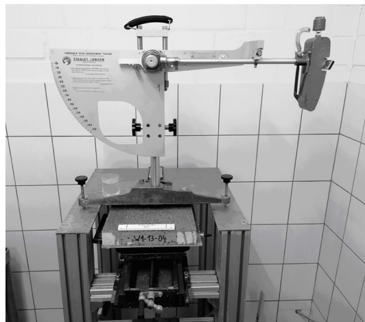
Bild 4: Prüftisch zur SRT-Messung der Platten mit Verschiebevorrichtung für die Betonplatten
